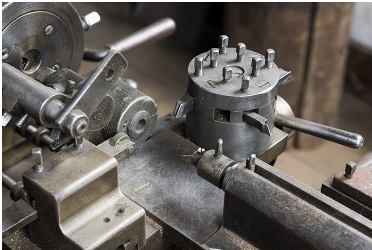
Détail de la partie travaillante : poupée avec passage de la barre (à gauche), tourelle revolver (au centre) et porte-outil d'extrémité (à droite).
