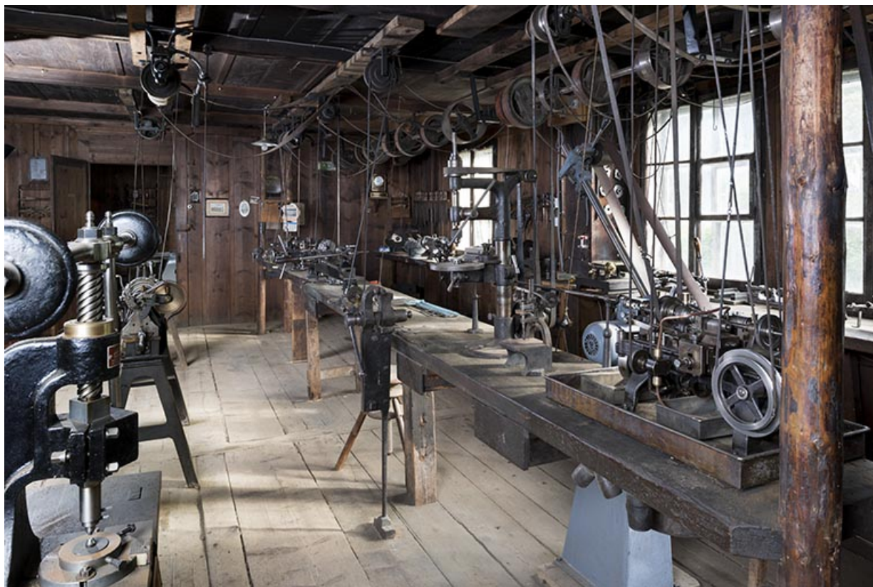
Vue d'ensemble de l'atelier et du système de transmission.
