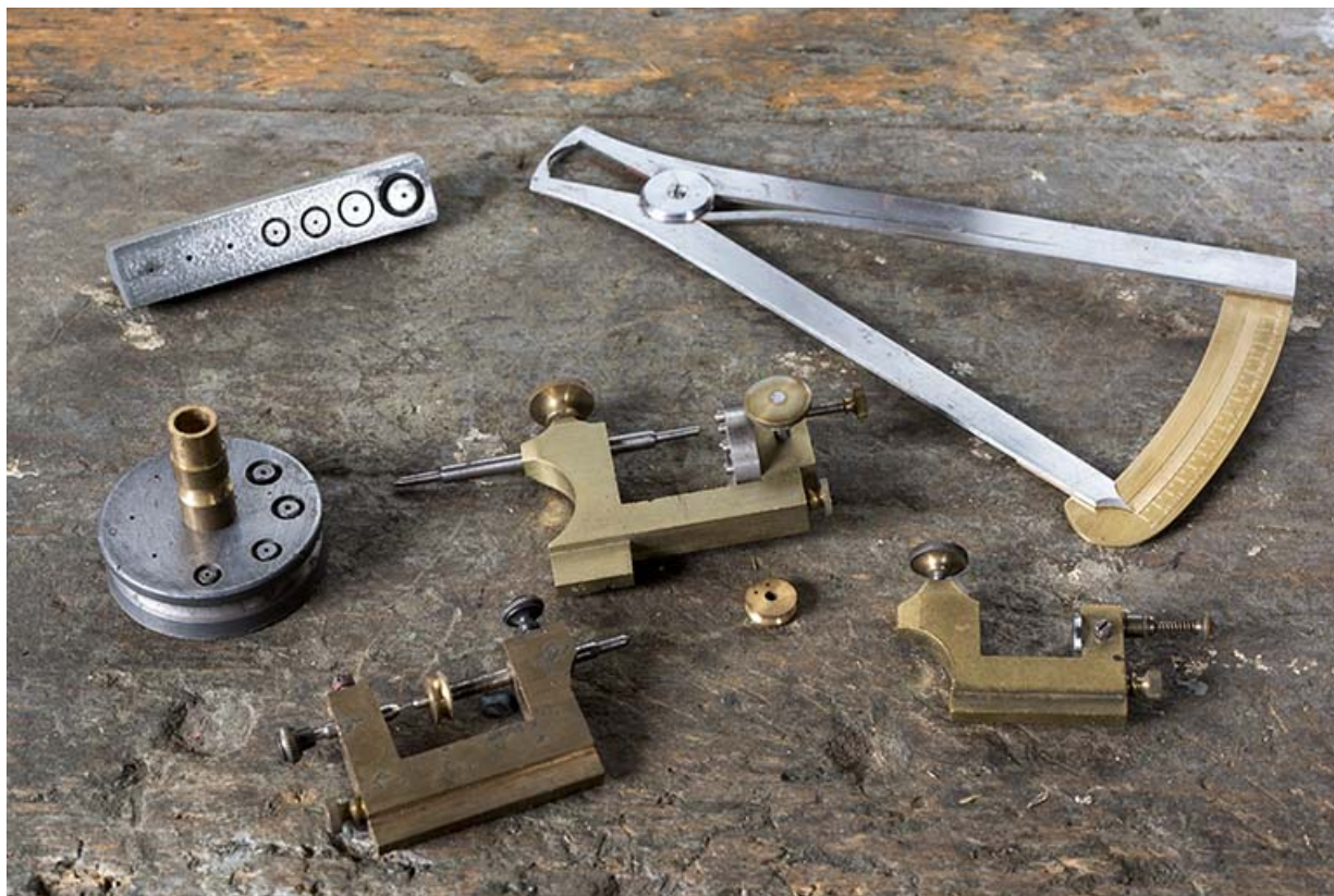
Exemple d'outils fabriqués dans l'atelier : outils à redresser les roues de cylindre (à gauche), au dixième (en haut à droite), à centrer et rapporter les pivots (les trois en bas autour d'un cuivrot, celui du haut étant dit à 12 cornets). 25, Les Gras
