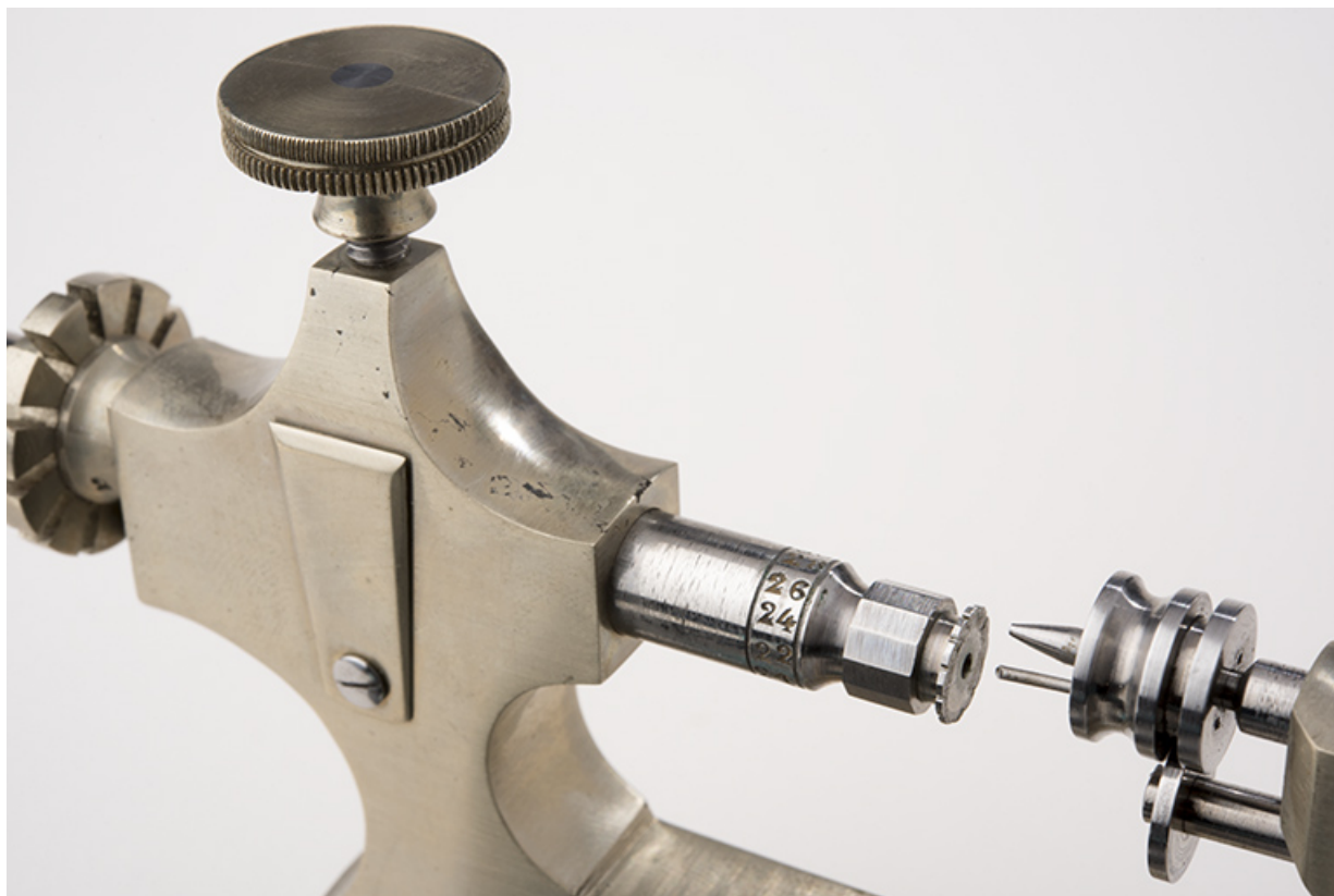
Poupée fixe et broche, montrant l'extrémité à coches. 25, Besançon
