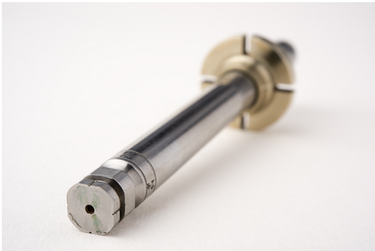
Petite broche : extrémité avec les quatre encoches.
