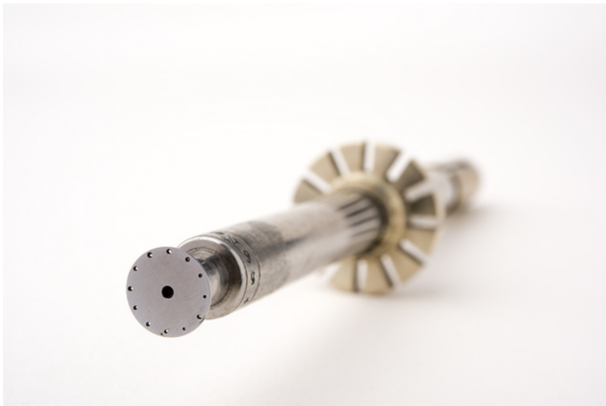
Grande broche : extrémité avec la lanterne. 25, Besançon
