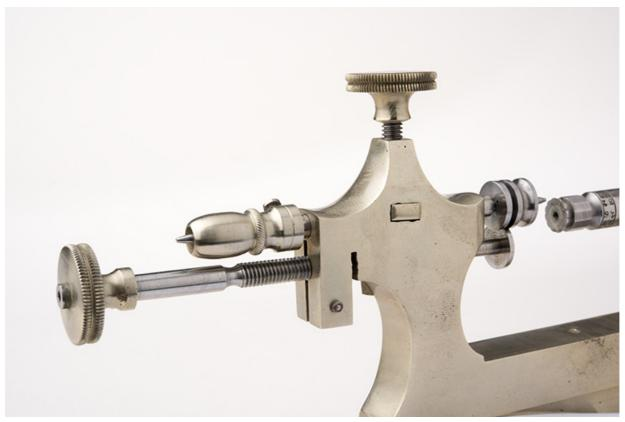
Poupée fixe, avec vis de rappel à gauche et poulie motrice à droite.
