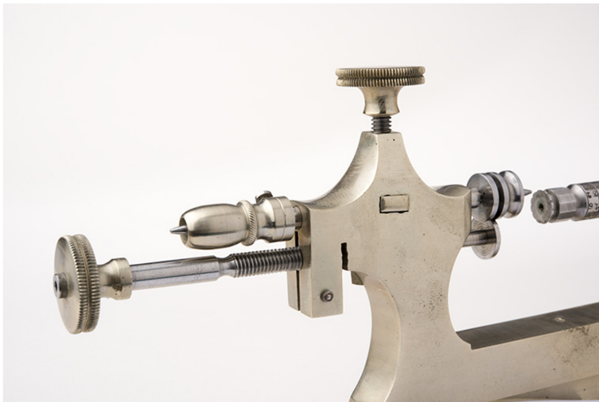
Poupée fixe, avec vis de rappel à gauche et poulie motrice à droite. 25, Besançon
