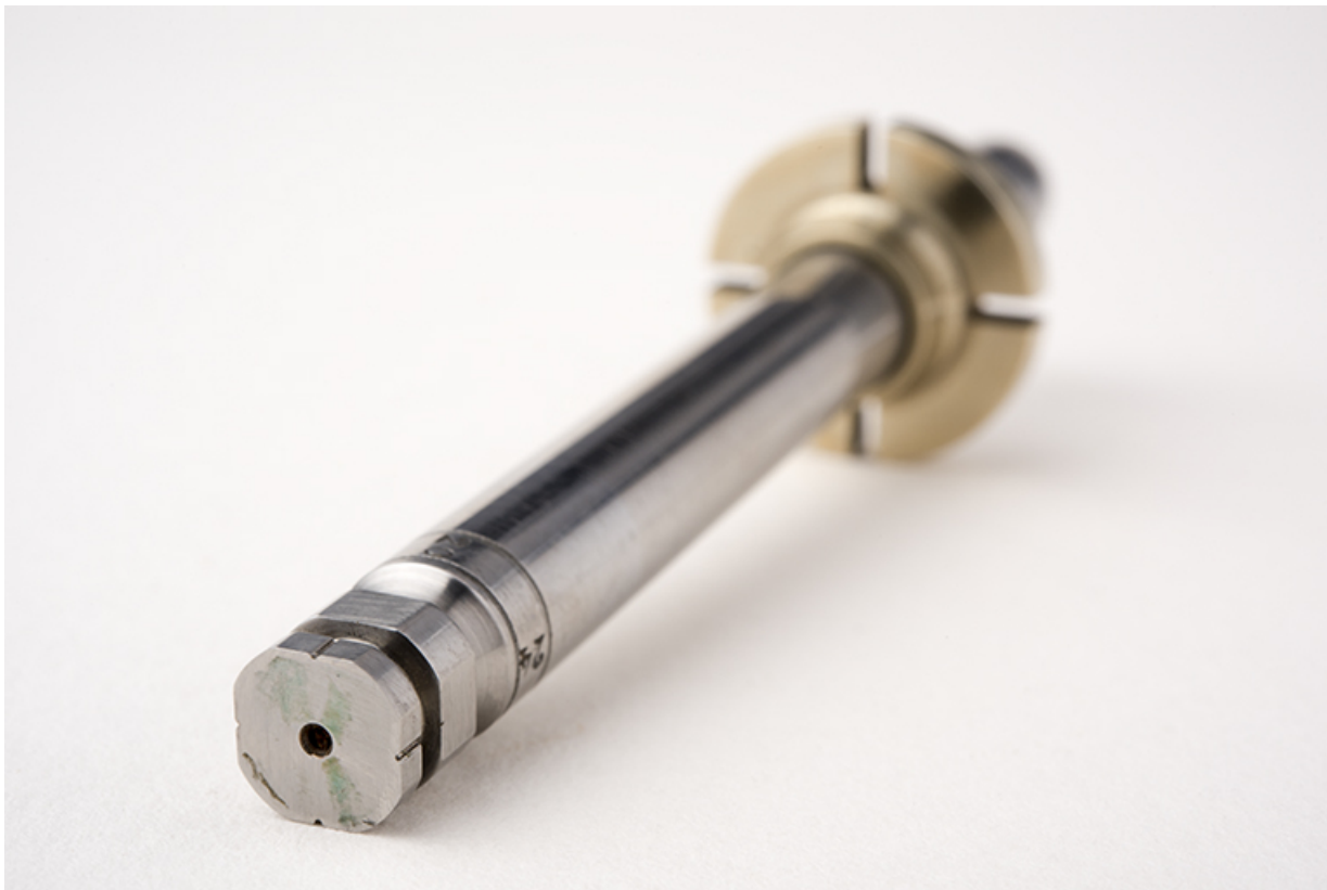
Petite broche : extrémité avec les quatre encoches.
