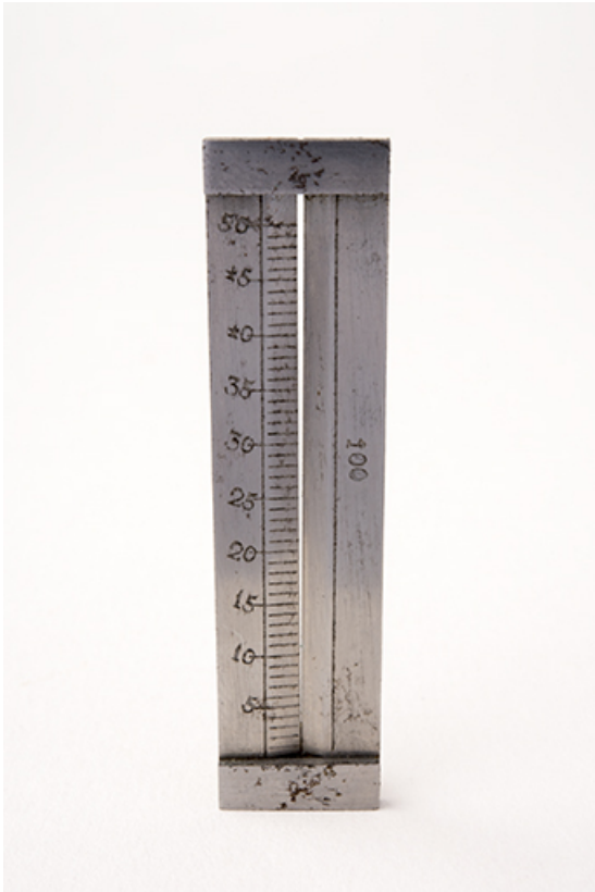
Calibre (jauge), gradué en centièmes de mm. 25, Besançon
