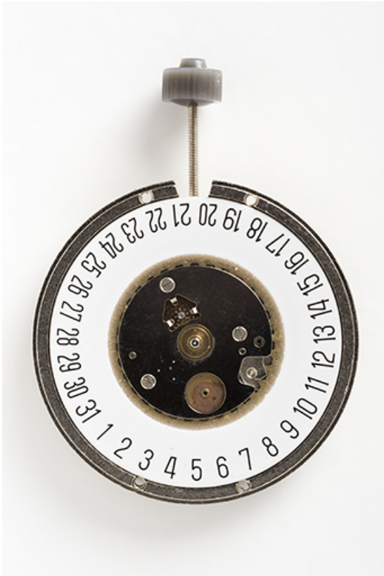
Mouvement France Ebauches FE 7221 : face côté cadran.
