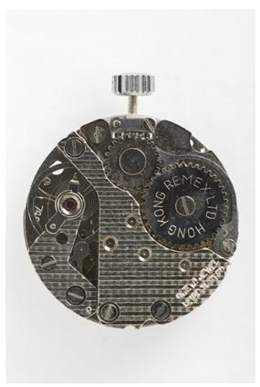
Mouvement Parrenin HP 740 : face côté ponts.
