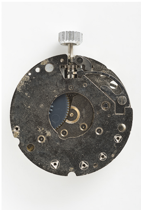
Mouvement Parrenin HP 740 : face côté cadran. 25, Villers-le-Lac
