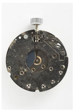
Mouvement Parrenin HP 740 : face côté cadran.
