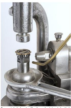
Support du balancier (fixation relevée), mèche (à droite) et système de lubrification (tuyau d'amenée et gouttière d'évacuation de l'huile). Un balancier achevé (il est muni de ses vis) a été posé sur le support.
