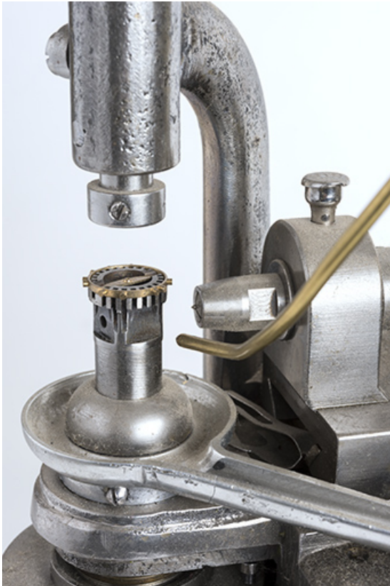
Support du balancier (fixation relevée), mèche (à droite) et système de lubrification (tuyau d'amenée et gouttière d'évacuation de l'huile). Un balancier achevé (il est muni de ses vis) a été posé sur le support.
