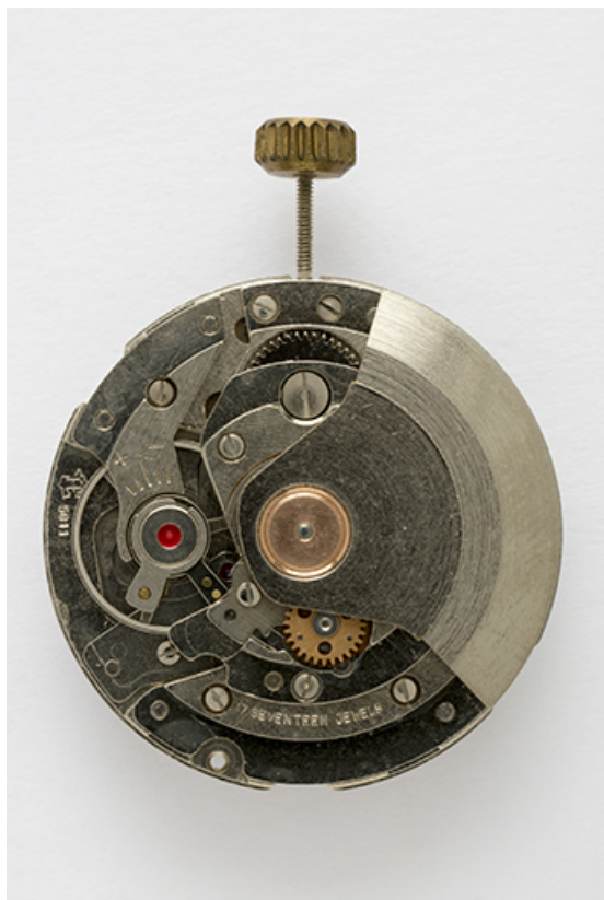
Mouvement France Ebauches FE 5611 : face côté ponts. 25, Villers-le-Lac
