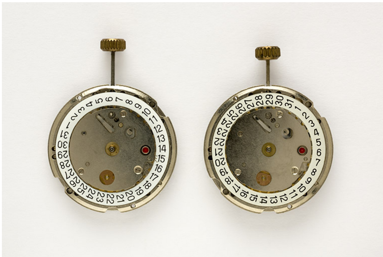
Mouvements France Ebauches FE 5601 (à gauche) et FE 5611 (à droite) : face côté cadran. 25, Villers-le-Lac
