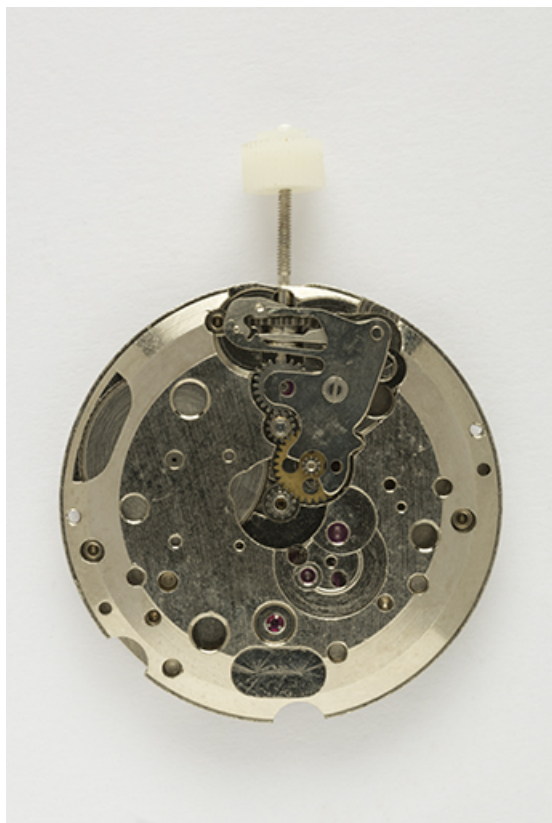
Mouvement France Ebauches FE 140-C : face côté cadran. 25, Villers-le-Lac
