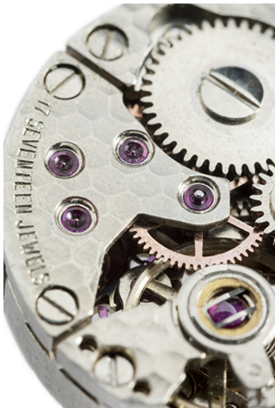
Mouvement FE 68-A : inscription et rubis sur le pont de rouage, avec amortisseur de chocs Epsilon Antichoc 102 au premier plan. 25, Villers-le-Lac
