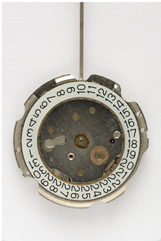
Mouvement France Ebauches FE 233-69-E-21 : face côté cadran. 25, Villers-le-Lac
