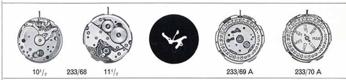
[Dessin des mouvements FE 233-68, 233-69A et 233-70A], 1973.
