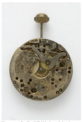
Mouvement Cupillard VC 233 : face côté cadran.
