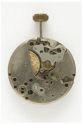
Mouvement Parrenin HP 90 : face côté cadran.
