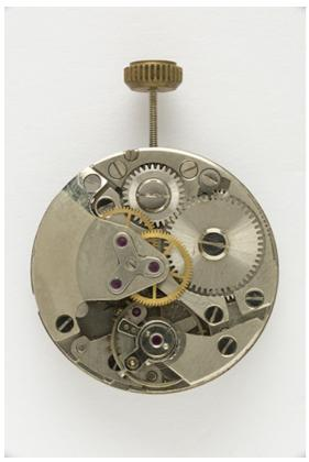
Mouvement Parrenin HP 90 : face côté ponts.
