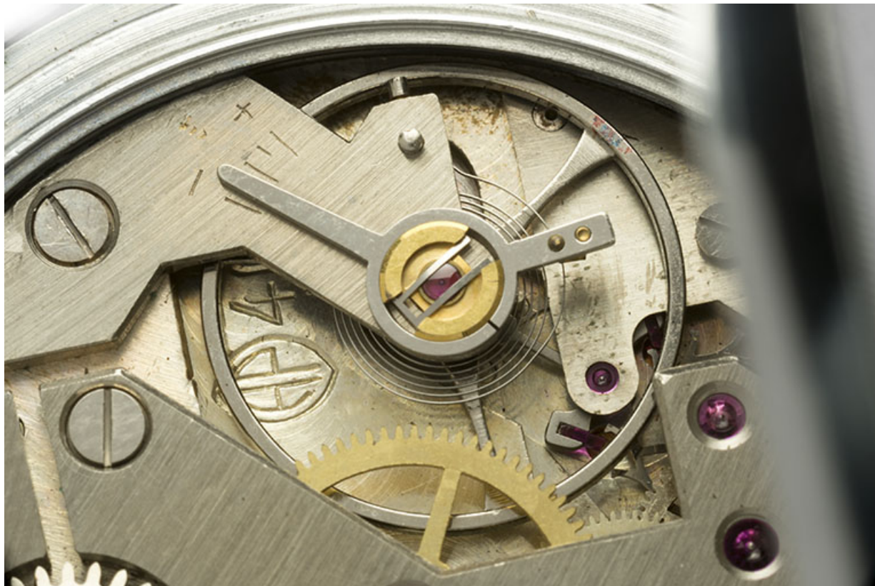
2e montre, mouvement Parrenin HP 40 : logotype et numéro de modèle gravés près du pont de balancier. 25, Villers-le-Lac
