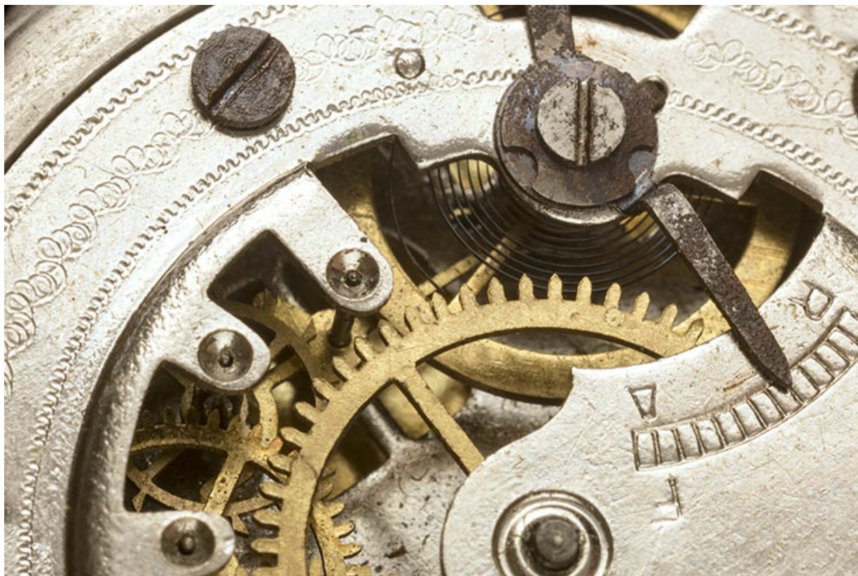
Mouvement : détail, avec la roue d'ancre à l'arrière-plan à gauche. 25, Villers-le-Lac
