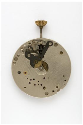
Mouvement Parrenin HP X40 : face côté cadran.
