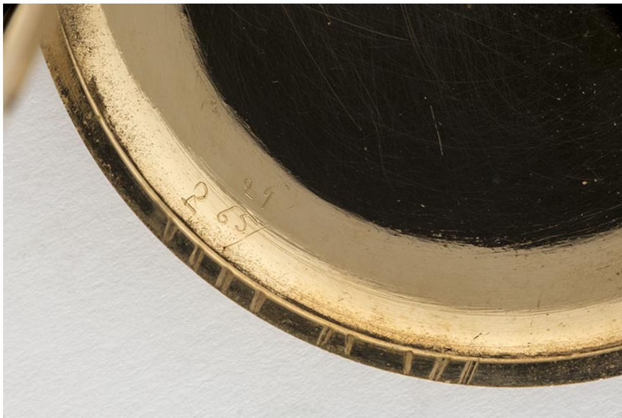
Inscription de rhabillage manuscrite gravée dans le fond et marques d'appariements sur la tranche. 25, Villers-le-Lac
