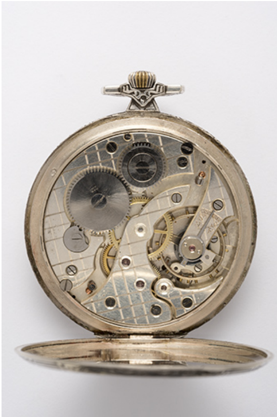
Mouvement Parrenin : calibre HP 18,5 U.
