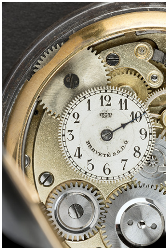
Mouvement : cadran de réglage du réveil. 25, Villers-le-Lac
