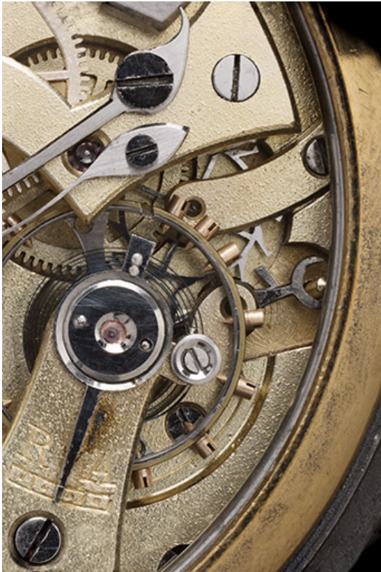
Mouvement : balancier, ancre et roue d'ancre. 25, Villers-le-Lac
