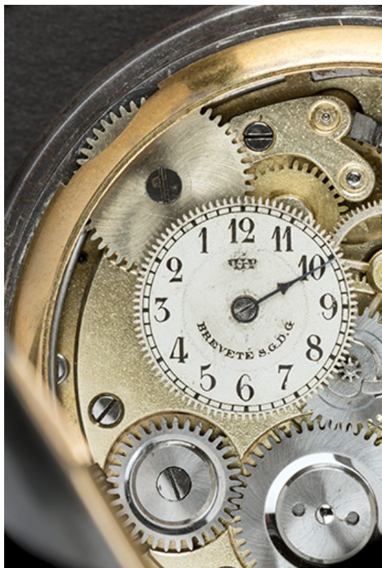
Mouvement : cadran de réglage du réveil. 25, Villers-le-Lac
