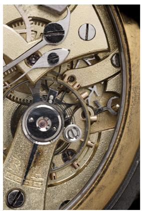
**Mouvement : balancier, ancre et roue d'ancre.** 25, Villers-le-Lac
