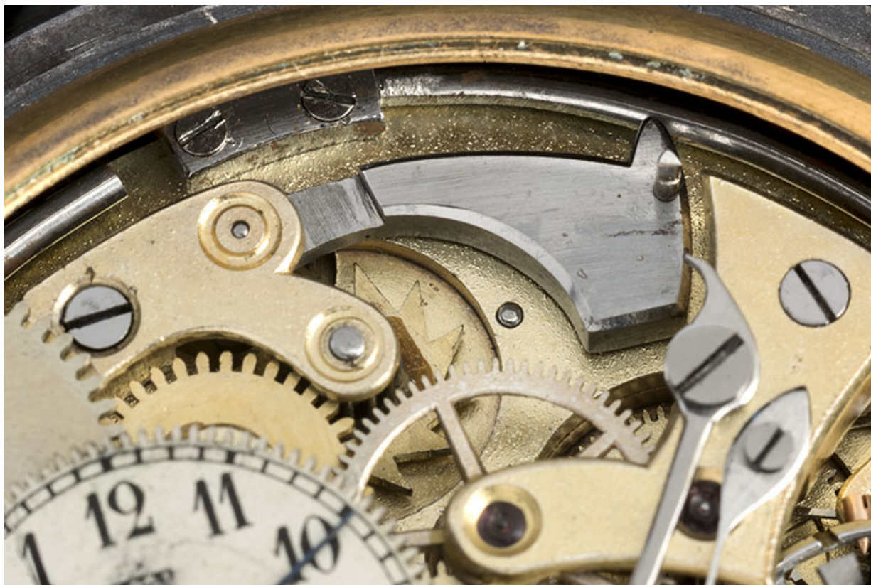
Mouvement : marteau et gong circulaire.
