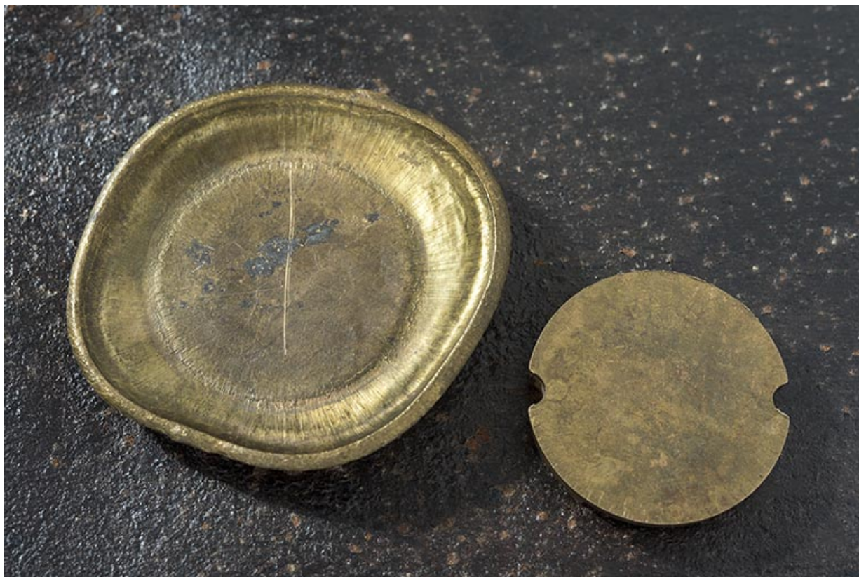
Ebauche obtenue par frappe à chaud (verso). 25, Villers-le-Lac
