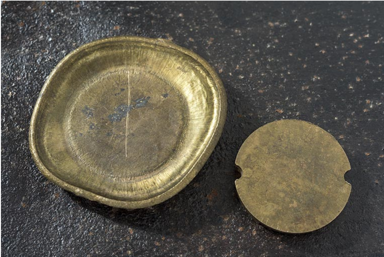
Ebauche obtenue par frappe à chaud (verso).
