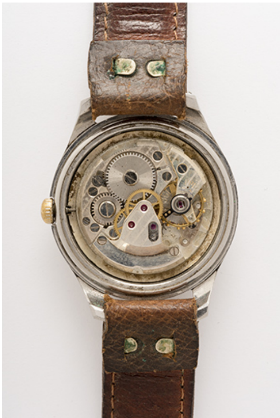
Montre-bracelet mécanique Manufrance : mouvement Parrenin HP 901.
