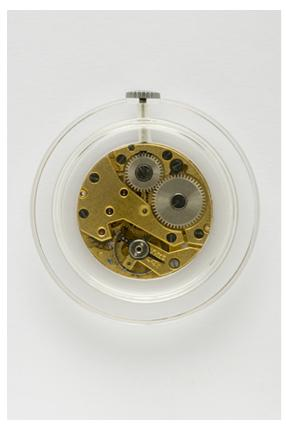
Mouvement Parrenin HP 87 : face côté ponts.
