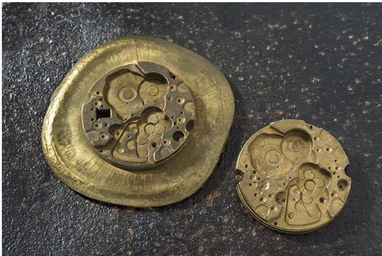
Ebauche obtenue par frappe à chaud (recto). Diamètre : 29,7 mm, épaisseur : 4,3 mm. 25, Villers-le-Lac
