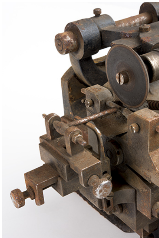
Système de fixation de la roue de cylindre et meule en carborandum.
