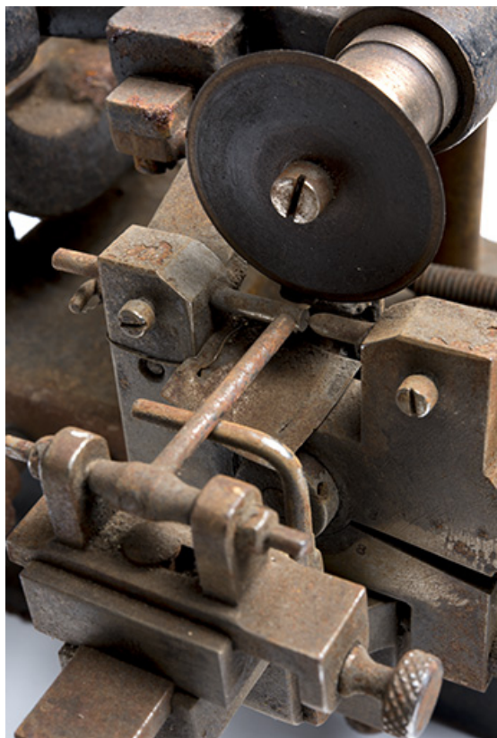
Système de fixation de la roue de cylindre et meule en carborandum, vus en plongée.
