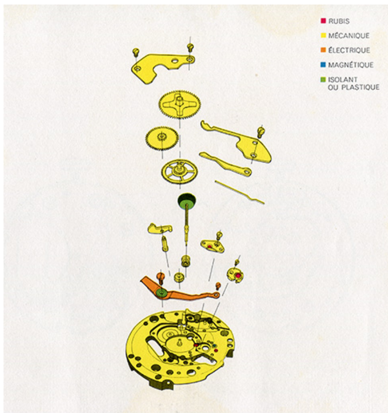
Lip Electronic R 148 [présentation sous forme d'éclaté : côté cadran], années 1960. 25, Maïche
