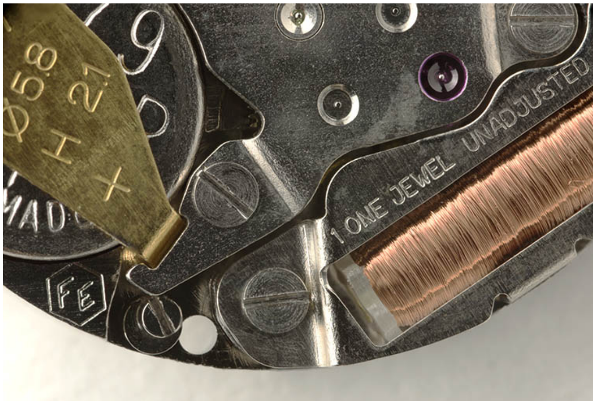
Module de montre à quartz France Ebauches FE 5120 : inscriptions diverses et logotype de la société. 25, Maïche
