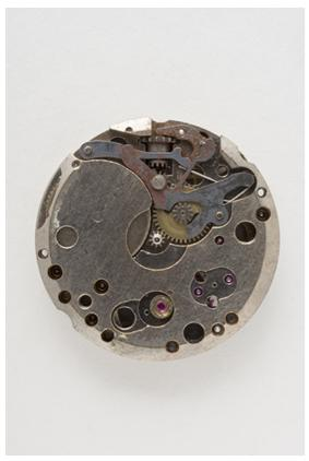
Mouvement Cupillard 233-60, vu côté cadran.
