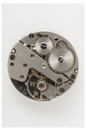
Mouvement Cupillard 233-60, vu côté ponts.
