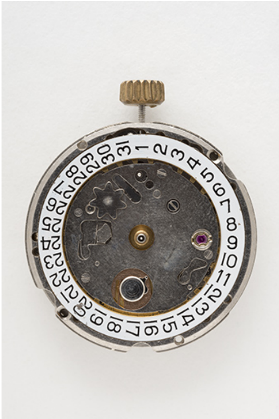
Mouvement de montre mécanique France Ebauches FE 4612 (côté cadran). 25, Maîche
