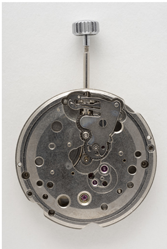
Mouvement FE 140-1, vu côté cadran. 25, Maïche
