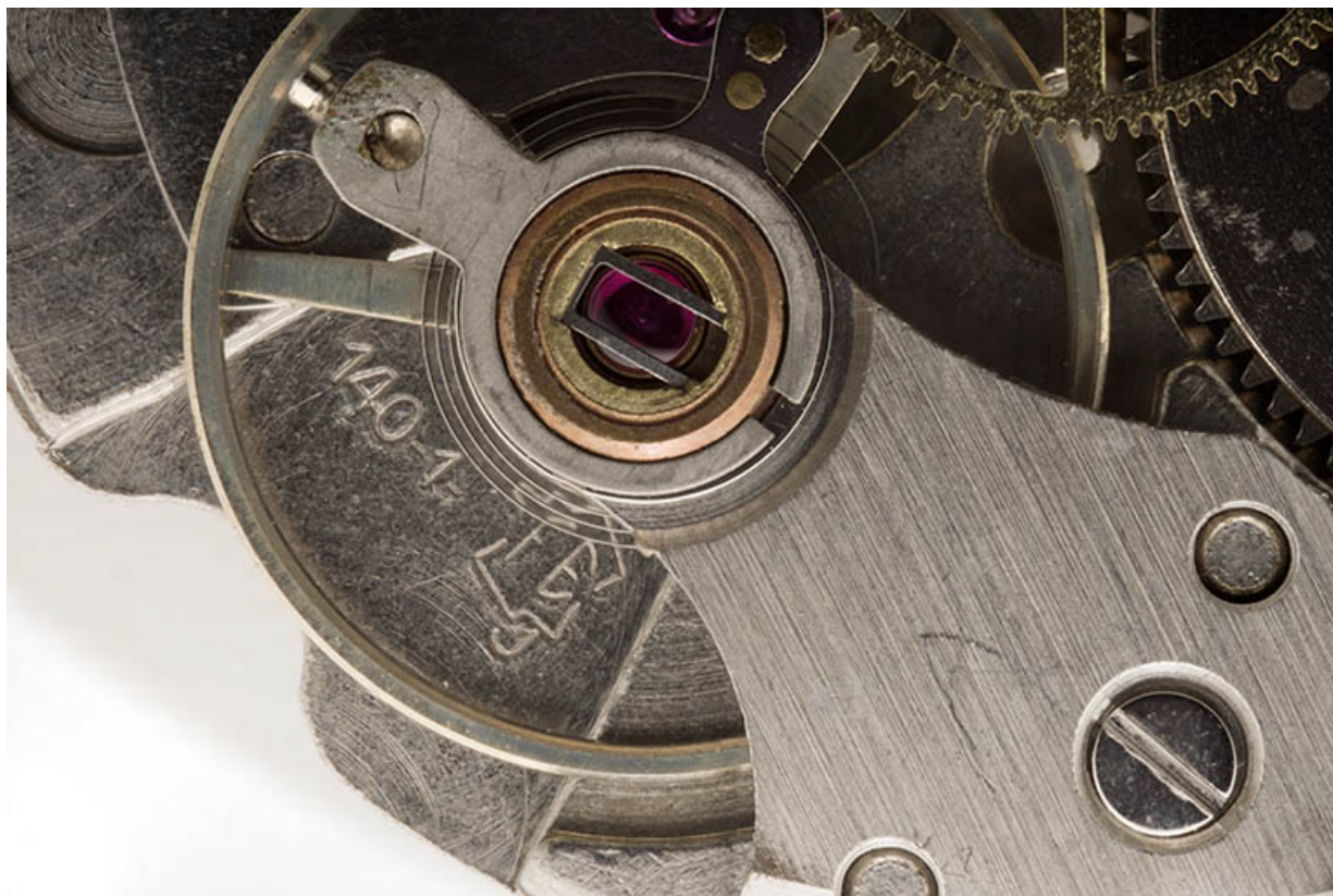
Mouvement FE 140-1 : logotype de la société France Ebauches et indication du modèle. 25, Maïche
