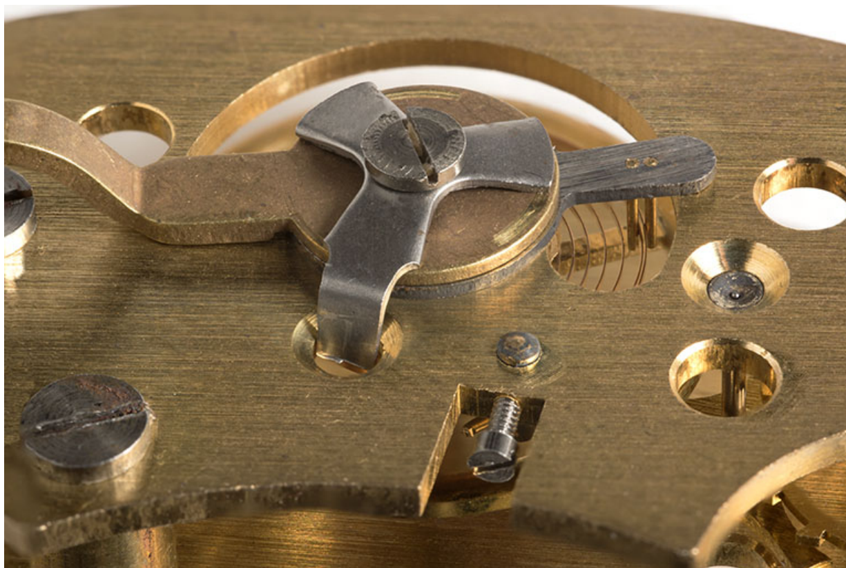
Système de réglage de l'avance/retard : raquette permettant de modifier la longueur active du spiral. 25, Maïche
