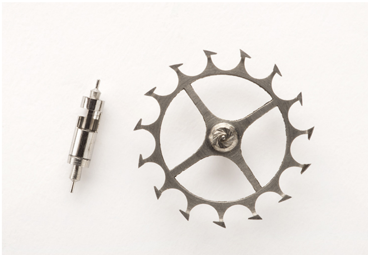
L'organe de partage et distribution du temps de la montre : l'échappement à cylindre (cylindre à gauche, roue de cylindre à droite). 25, Charquemont, 12 Rue Neuve
