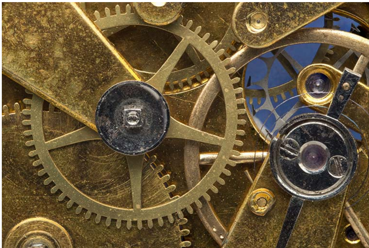
Détail de la face côté ponts : roue des minutes à gauche, balancier-spiral et raquette à gauche. 25, Charquemont, 12 Rue Neuve
