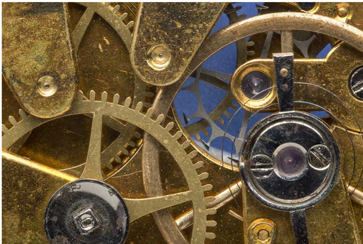
Détail de la face côté ponts : roue des minutes à gauche, balancier-spiral et raquette à gauche (vue rapprochée). 25, Charquemont, 12 Rue Neuve
