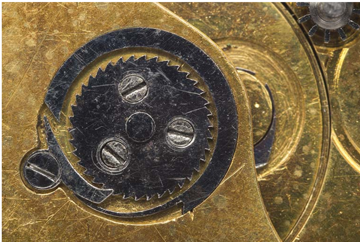
Détail de la face côté cadran : cliquet et roue d'encliquetage du barillet. 25, Charquemont, 12 Rue Neuve
