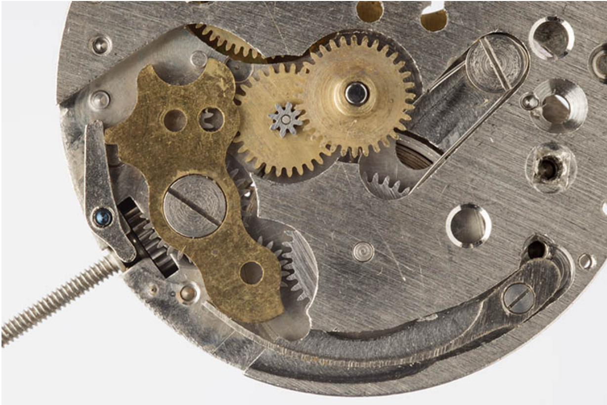
2e mouvement, côté cadran : mécanisme du remontoir. De gauche à droite, tige de remontoir et son pignon, plaque protégeant les renvois, roue de minuterie et son pignon, canon.
