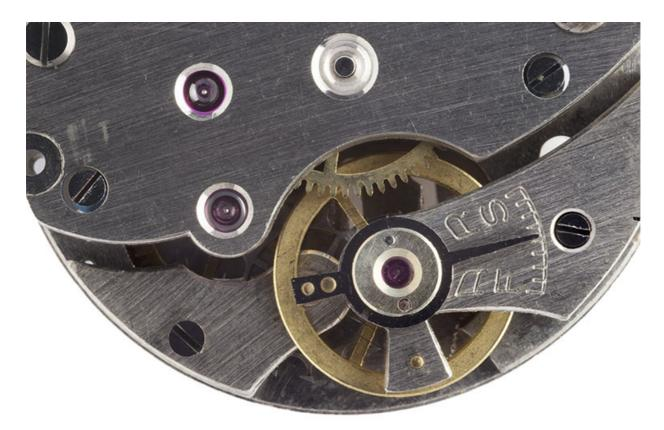
1er mouvement, détail côté ponts : balancier-spiral et mécanisme de réglage de la marche diurne. La roue de cylindre se devine à l'arrière-plan.
