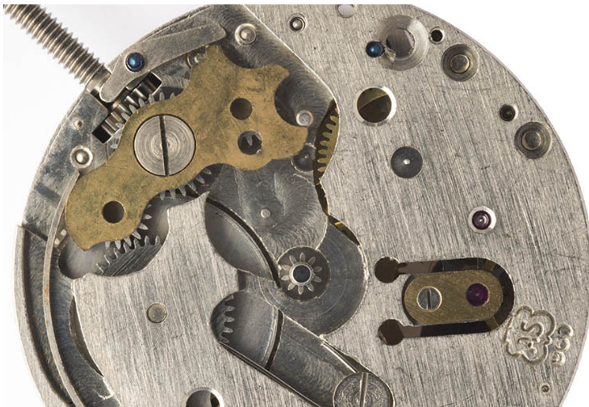
1er mouvement, côté cadran : mécanisme du remontoir. A droite, le logo de la société A. Schild SA. 25, Charquemont, 12 Rue Neuve
