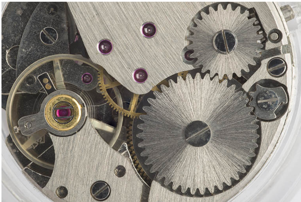
Détail : de gauche à droite, balancier-spiral, rochet et roue de couronne (côté ponts). 25, Charquemont, 12 Rue Neuve
