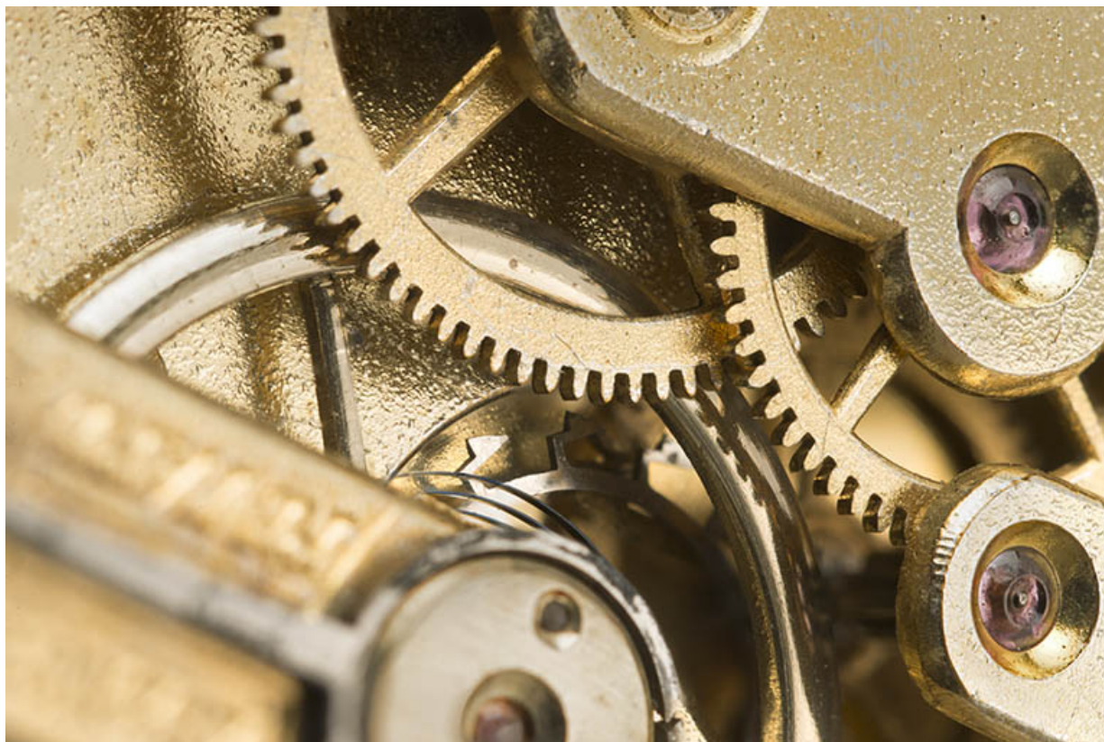
Détail du rouage : la roue de cylindre plate est visible à l'arrière du balancier.
