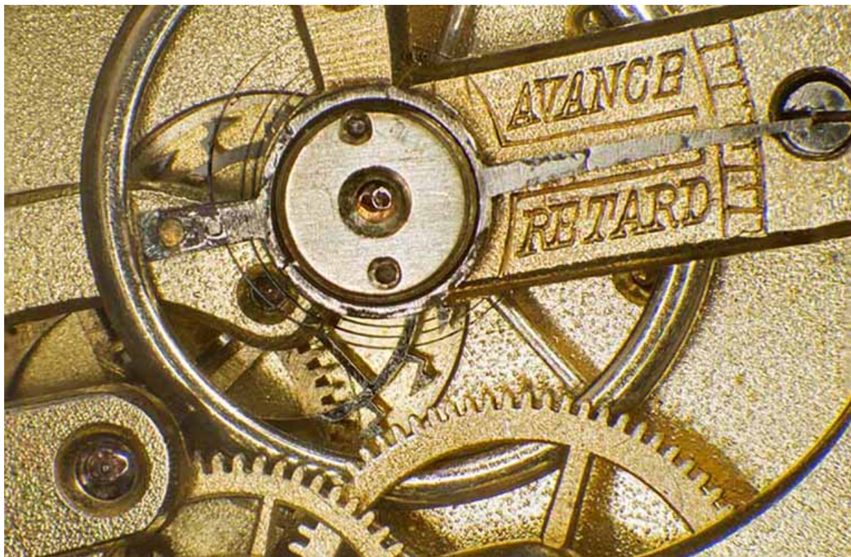
Mécanisme de réglage de la marche diurne : raquette sur le pont de balancier. 25, Charquemont, 12 Rue Neuve
