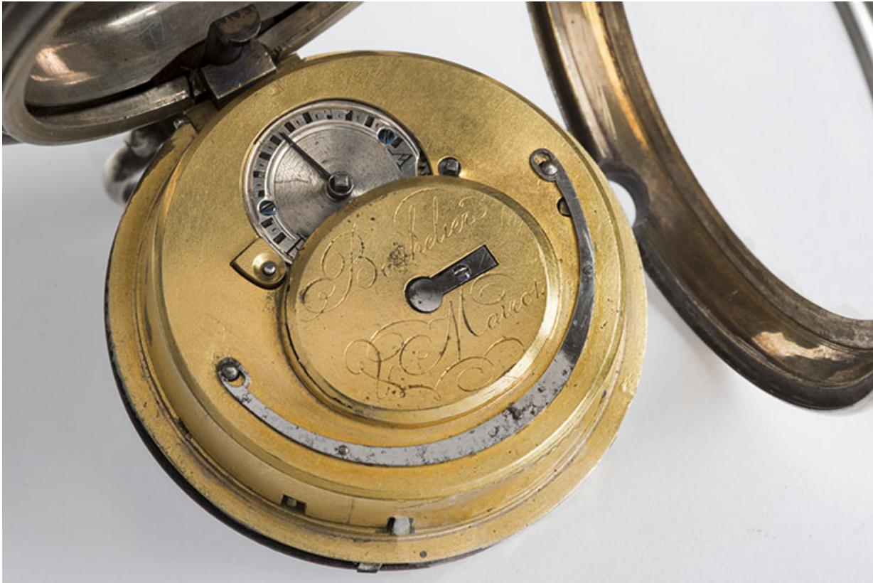
Platine supérieure, coq et raquette (système de réglage de l'avance / retard). 25, Charquemont, 12 Rue Neuve
