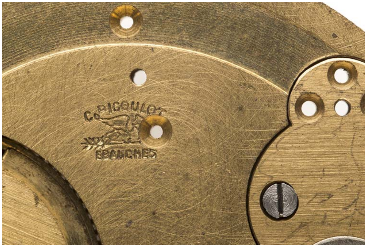
Platine nue, côté cadran : marque du fabricant avec inscription (C. Picoulot / Ebauches) et griffon couché sur une flèche. 25, Charquemont, 12 Rue Neuve
