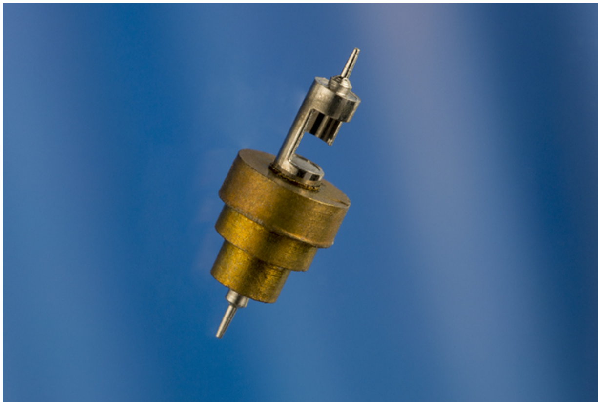
Echappement à cylindre : cylindre (en métal blanc) équipé de la "siette" (assise du balancier) en laiton. 25, Charquemont, 12 Rue Neuve
