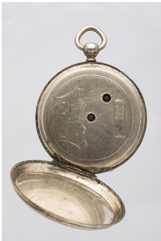
Montre de gousset de la fin du 18e siècle ou du début du 19e siècle : la cuvette. Inscription gravée dans l'écusson : Cylindre / Huit Rubis. Noter les deux trous destinés à la clé utilisée pour le remontage et la mise à l'heure.
