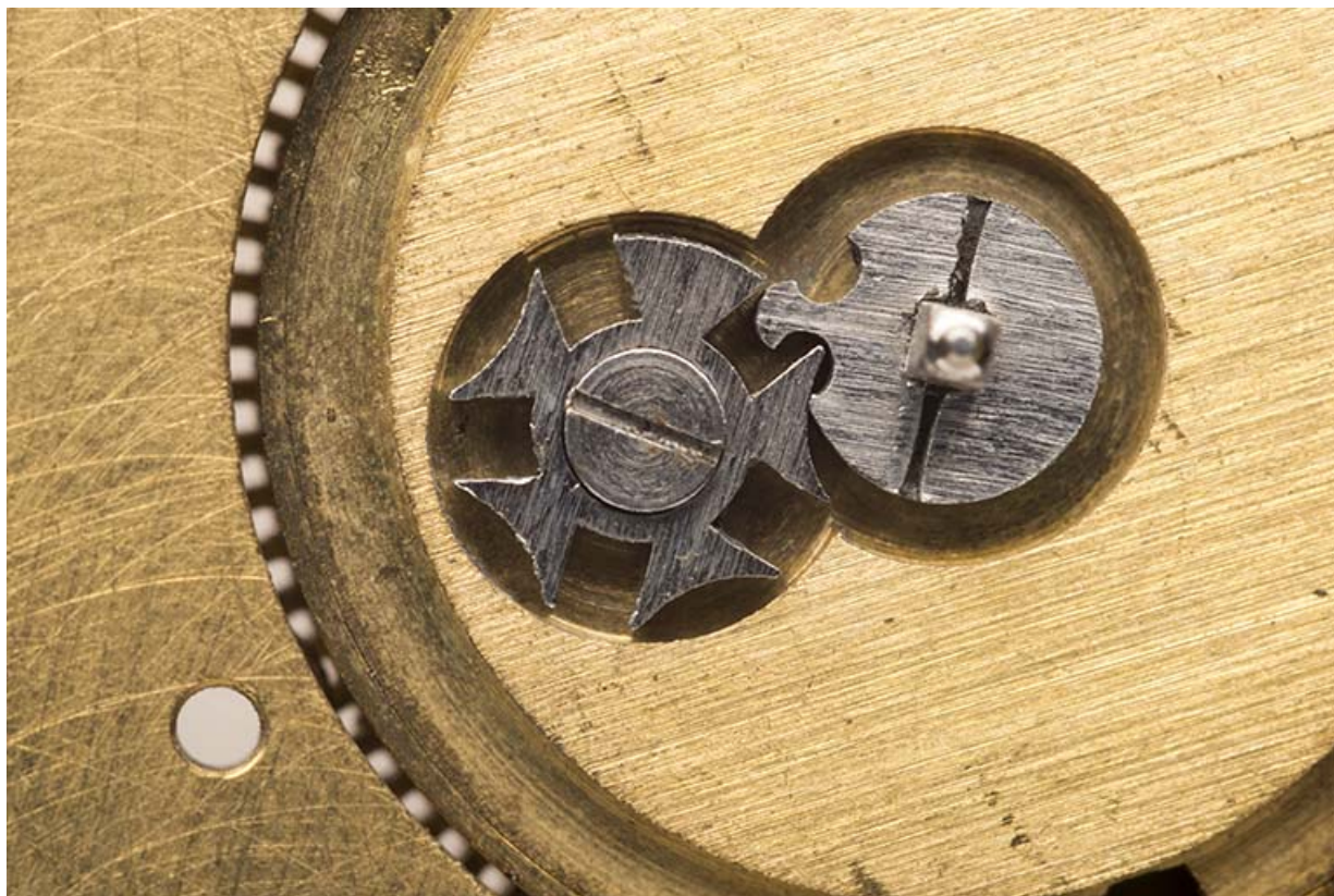
Platine nue, côté cadran : le système d'arrêtage du barillet (croix de Malte), permettant de limiter le degré d'armage du ressort moteur.
