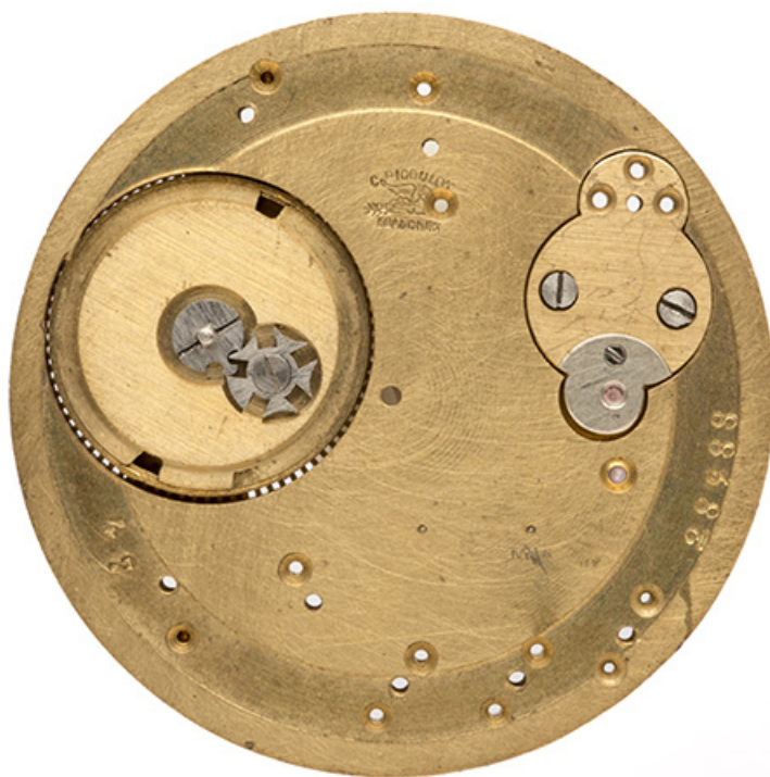
Platine nue, vue du côté cadran. Noter le barillet et son système d'arrêtage (croix de Malte) à gauche, le chariot à droite. 25, Charquemont, 12 Rue Neuve
