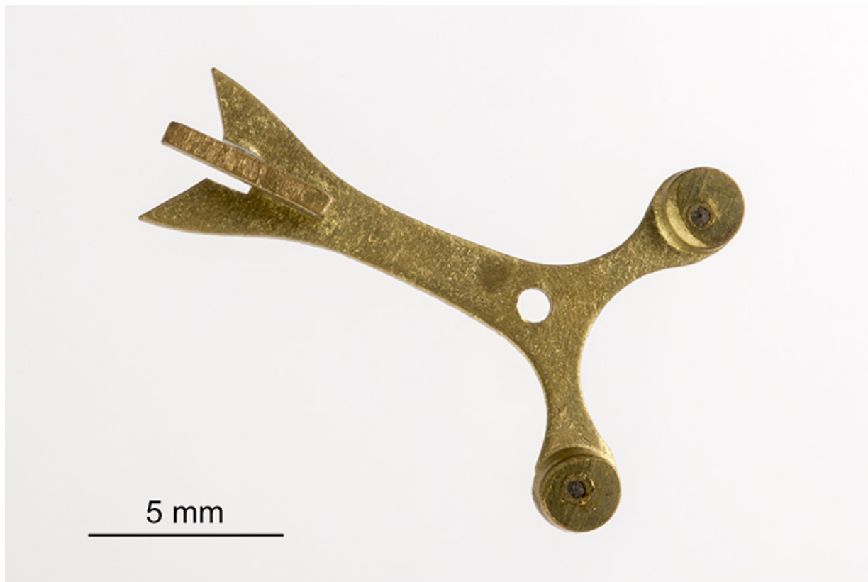
Echappement à chevilles : ancre (2e face).
