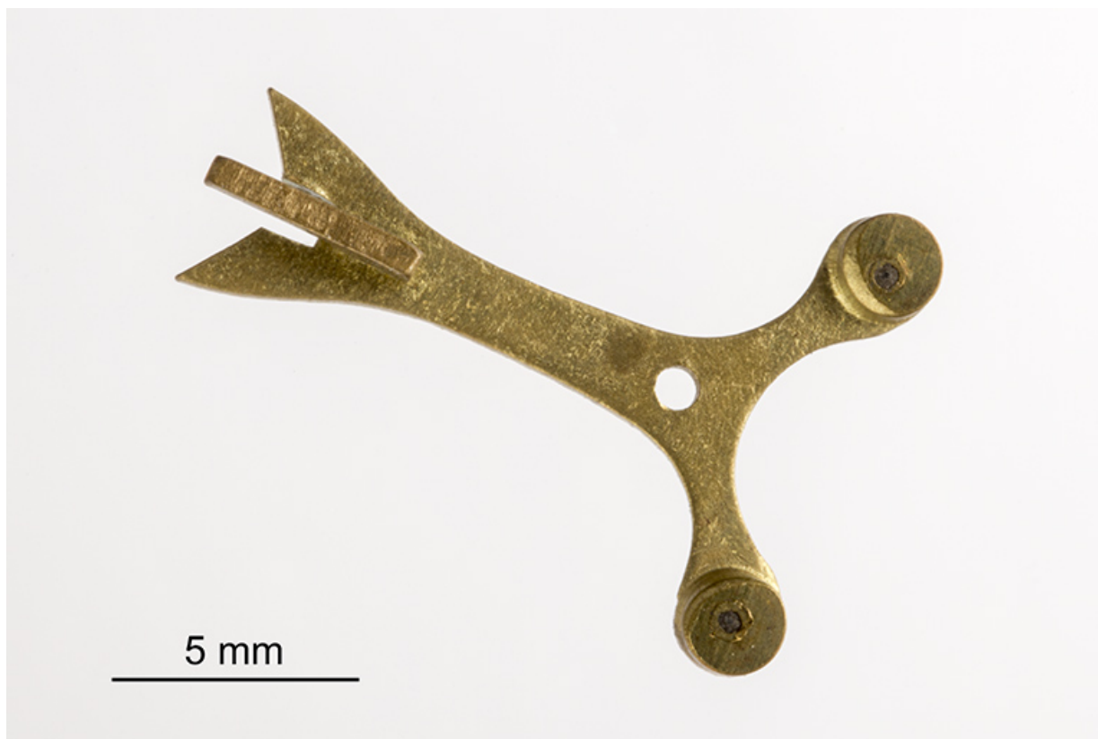
Echappement à chevilles : ancre (2e face).
