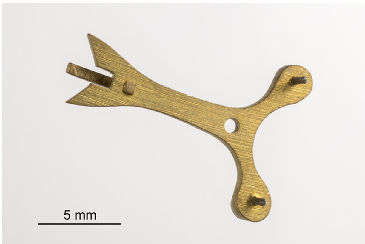
Echappement à chevilles : ancre (les chevilles sont visibles à droite). 25, Charquemont, 12 Rue Neuve
