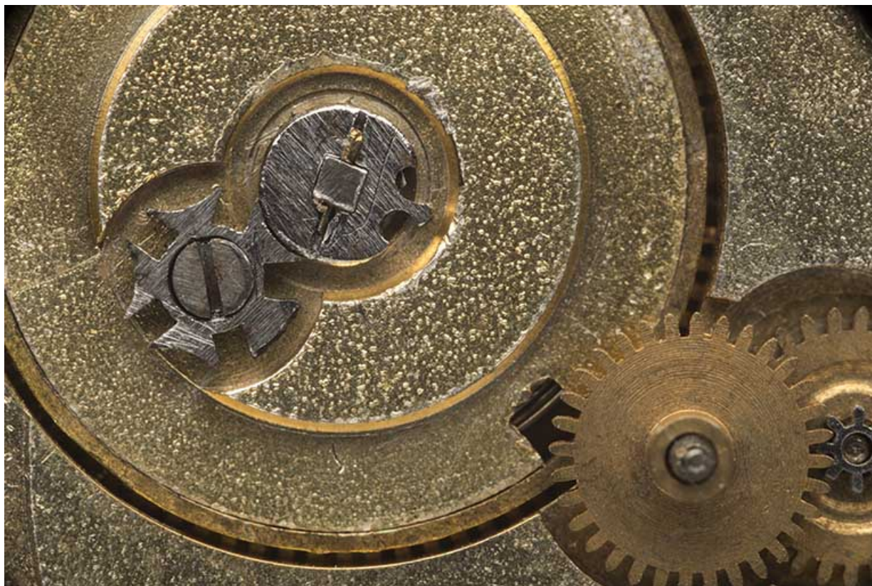
Montre de gousset de la fin du 18e siècle ou du début du 19e siècle : la croix de Malte (système d'arréage permettant de limiter le degré d'armage du barillet).
