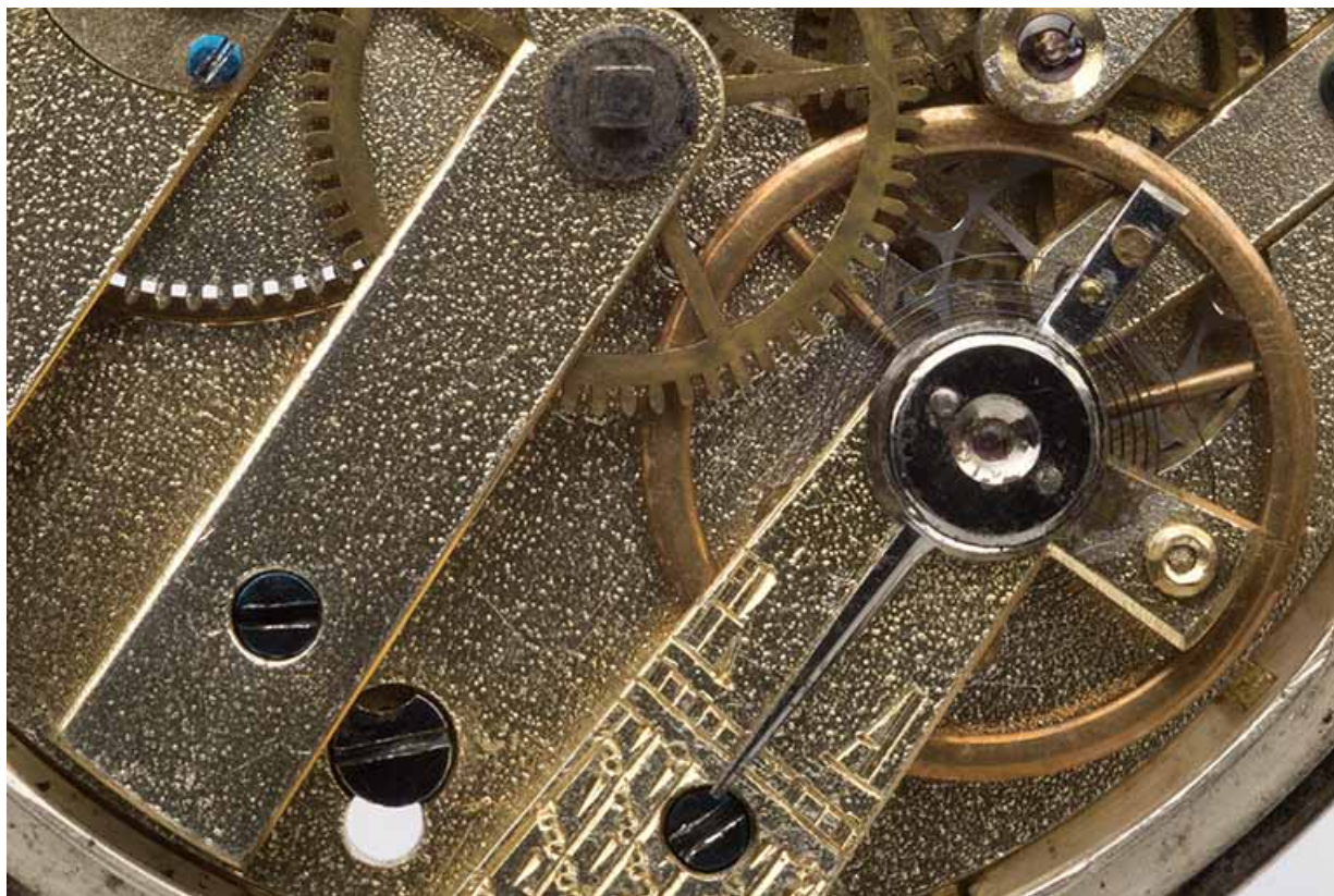
Montre de gousset de la fin du 18e siècle ou du début du 19e siècle : l'échappement à cylindre. Sont visibles le balancier roskopf et son spiral, la raquette et le coq, un pont.
