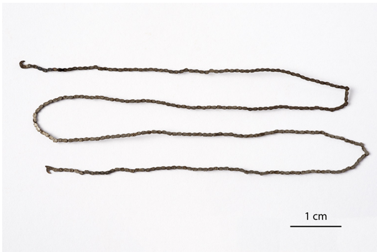
Chaîne de fusée en acier (27 cm de long). Ce type de chaîne était fabriqué à domicile, plutôt par des femmes. 25, Charquemont, 12 Rue Neuve
