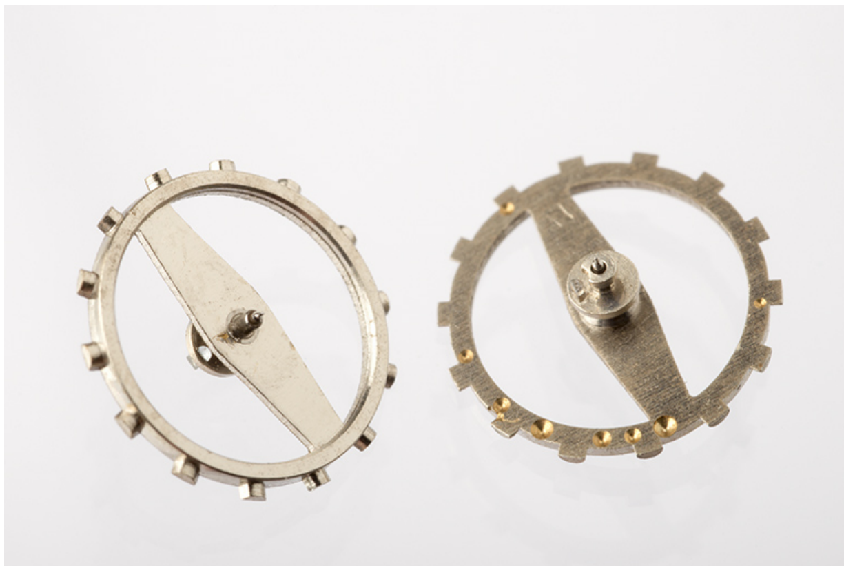
Deux balanciers monométalliques. Les vis sont purement décoratives, le réglage du balourd se faisant par fraisage au verso (balancier de droite, montrant également les plateaux et la cheville pour un échappement à ancre).
