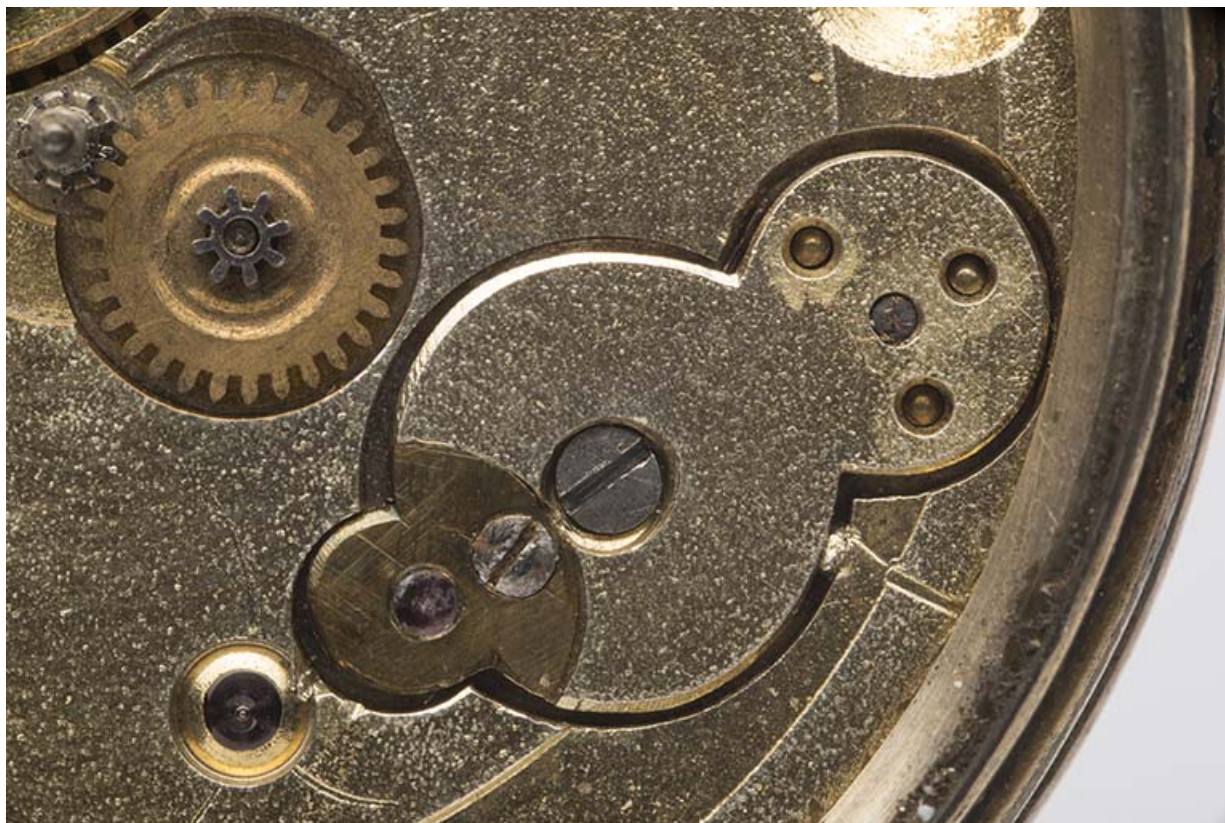
Montre de gousset de la fin du 18e siècle ou du début du 19e siècle : le chariot ou char (pièce mobile destinée au réglage de la distance entre les centres du cylindre et de sa roue).
