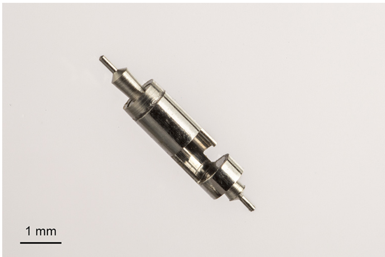
Echappement à cylindre : cylindre 18 ligne commercialisé par le comptoir Cyrax. 25, Charquemont, 12 Rue Neuve
