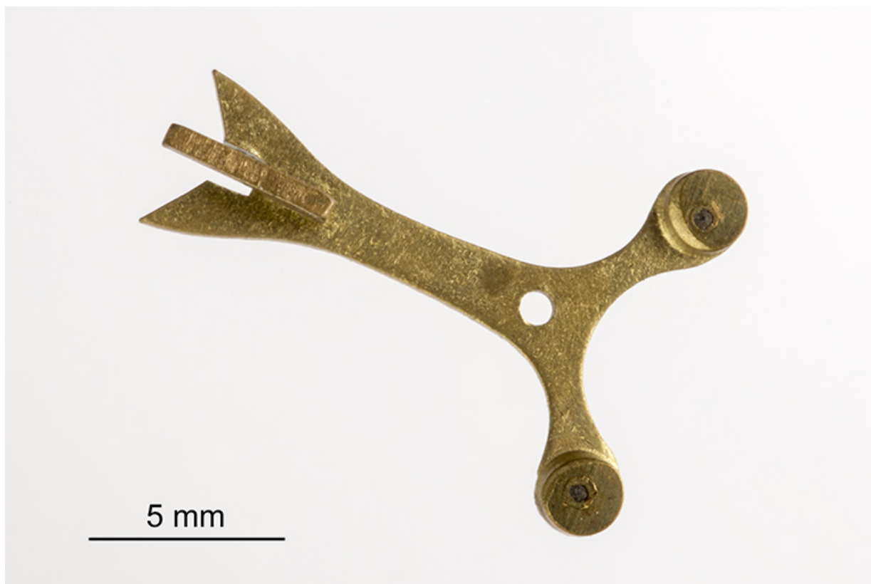
Echappement à chevilles : ancre (2e face).
