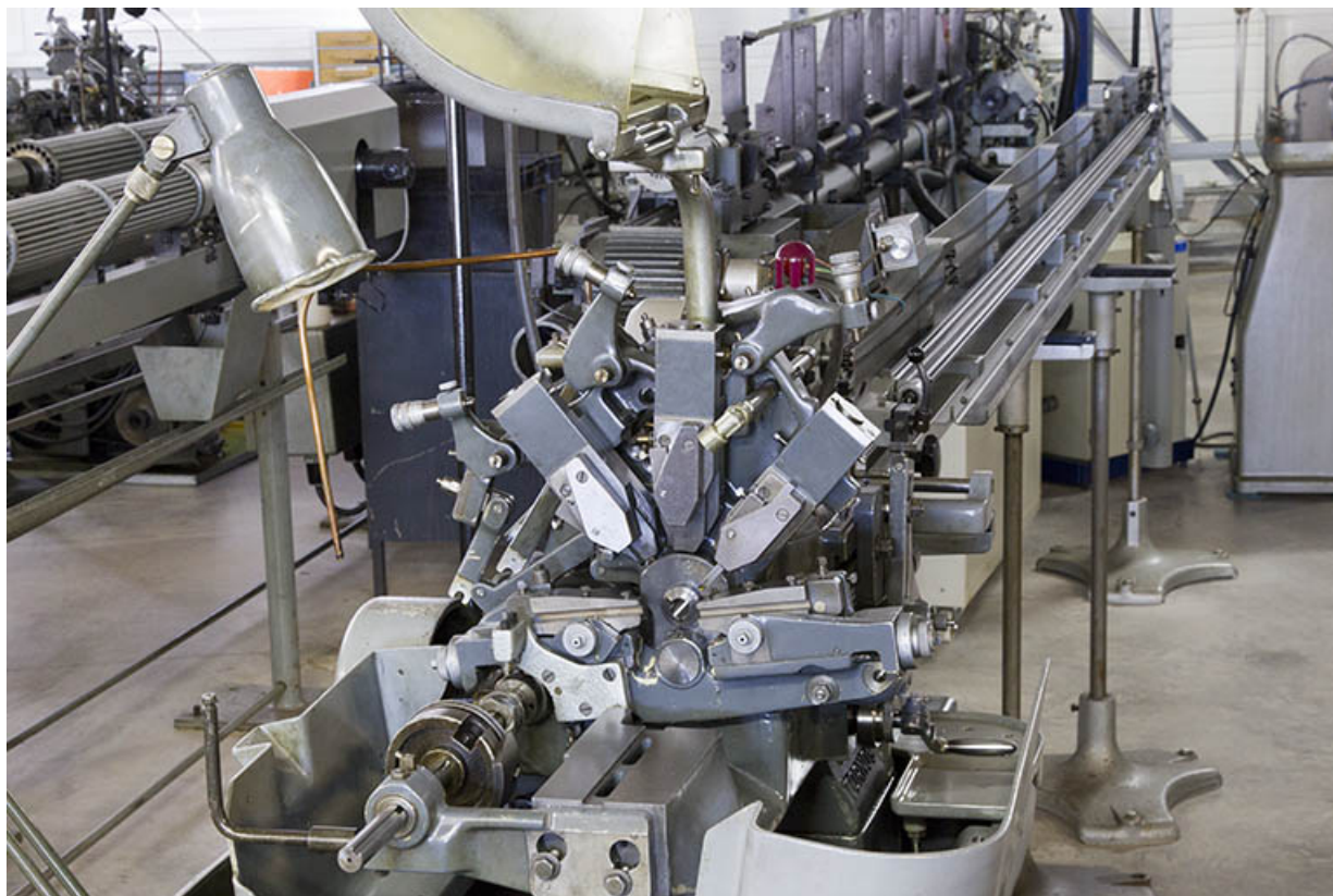
Machine à décolleter Tornos M-7 : usine de décolletage des Ets Perrenoud (rue Pierre Mendès-France), 25, Charquemont
