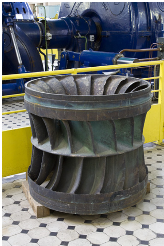
Roue d'une turbine Francis double.
