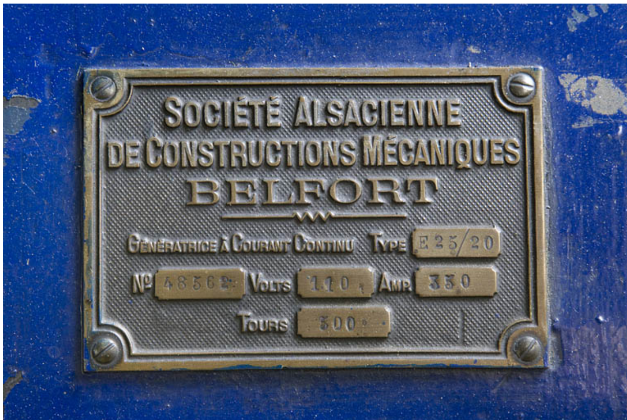
Groupe n° 2 : plaque signalétique de l'alternateur.
