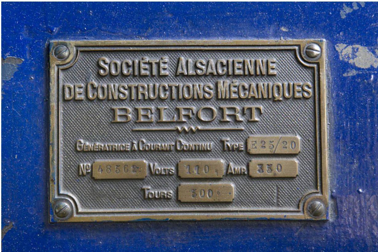
Groupe n° 2 : plaque signalétique de l'alternateur.
