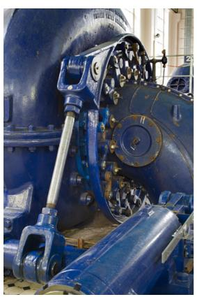
Groupe  $n^\circ\,\mathbf{1}$  : bras et cercle de vannage de la turbine, permettant d'en régler le débit.
