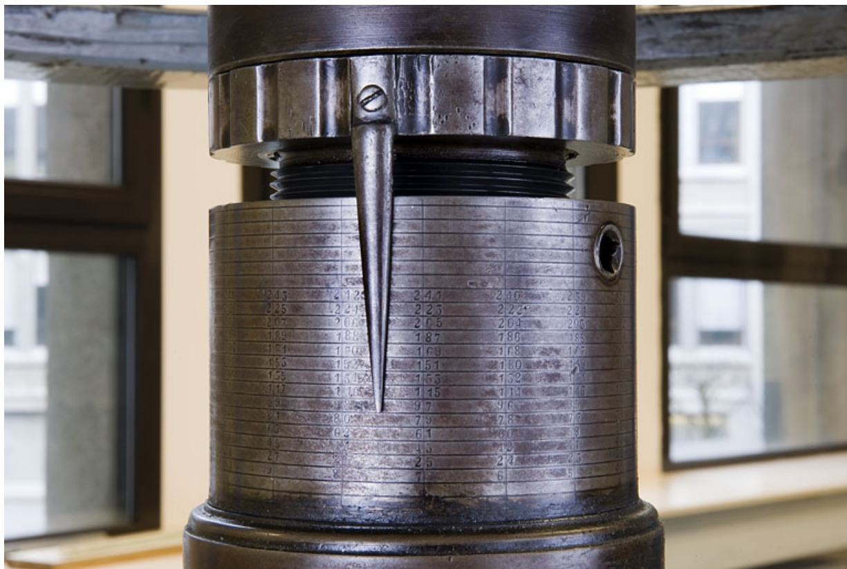
Graduations du système de réglage au dixième de mm.
