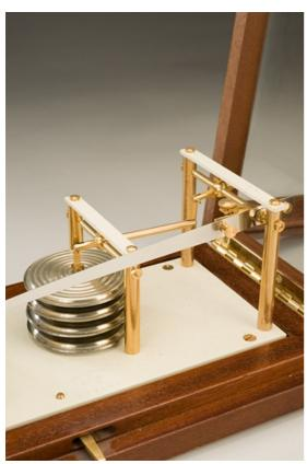
Capsules de Vidi et système de transmission du mouvement à l'aiguille. 25, Besançon, 1 rue Labbé
