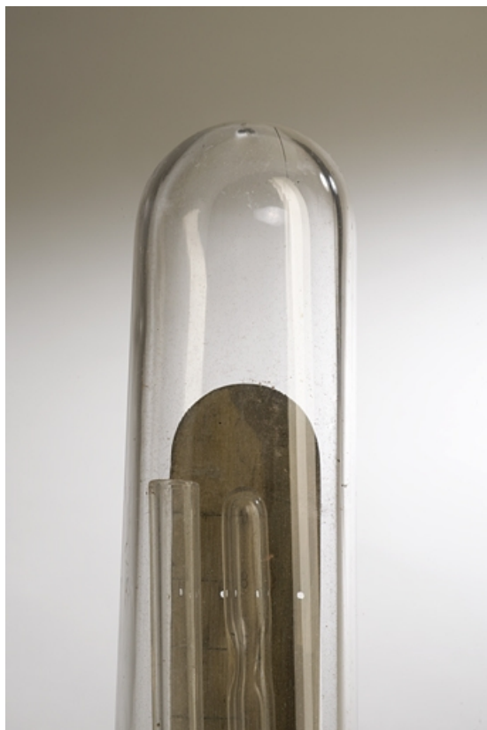
Grand manomètre : extrémités ouverte et fermée du baromètre contenu dans l'éprouvette. 25, Besançon, 1 rue Labbé
