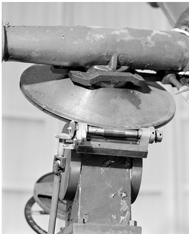
Système de rotation : engrenages, vis sans fin et disque denté. 25, Besançon, 1 rue Labbé
