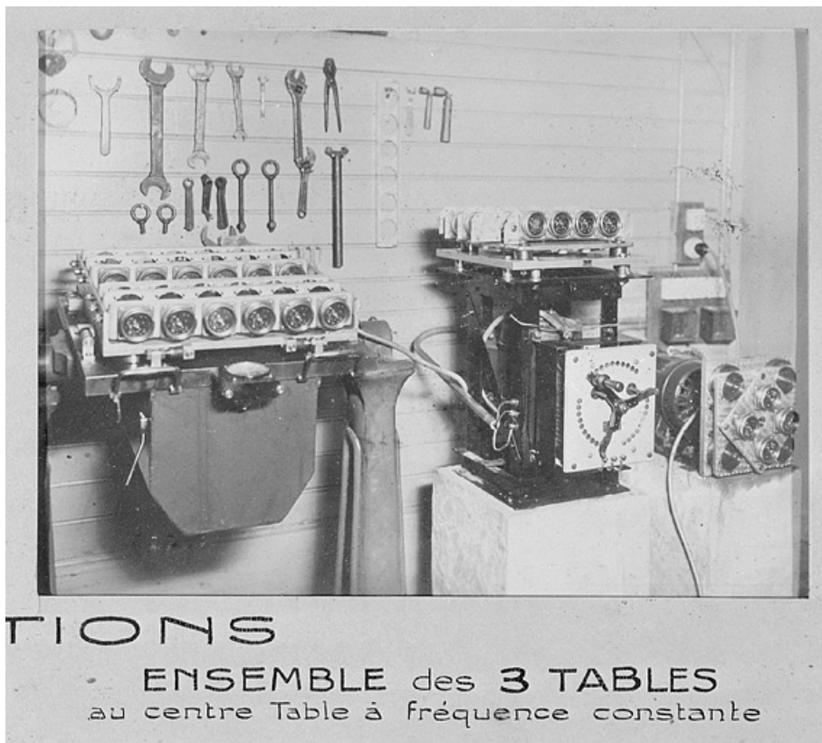
Essais de vibrations. Ensemble de 3 tables. Au centre table à fréquence constante, entre 1932 et 1934. 25, Besançon, 34, 36, 41 à 43 avenue de l' Observatoire, lieudit : la Bouloie
