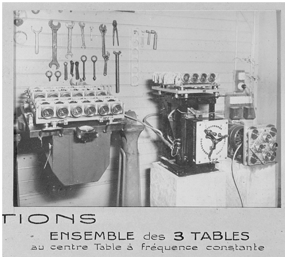
Essais de vibrations. Ensemble de 3 tables. Au centre table à fréquence constante, entre 1932 et 1934.
