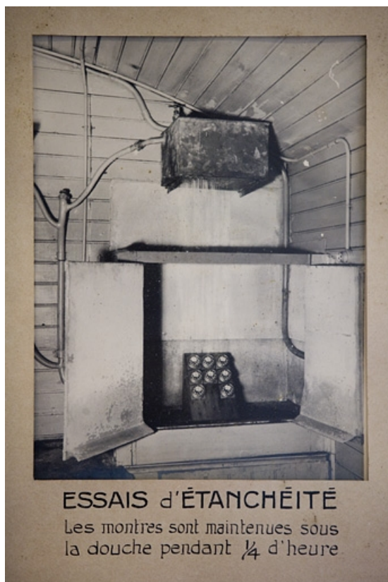
Essais d'étanchéité. Les montres sont maintenues sous la douche pendant 1/4 d'heure, entre 1932 et 1934.
