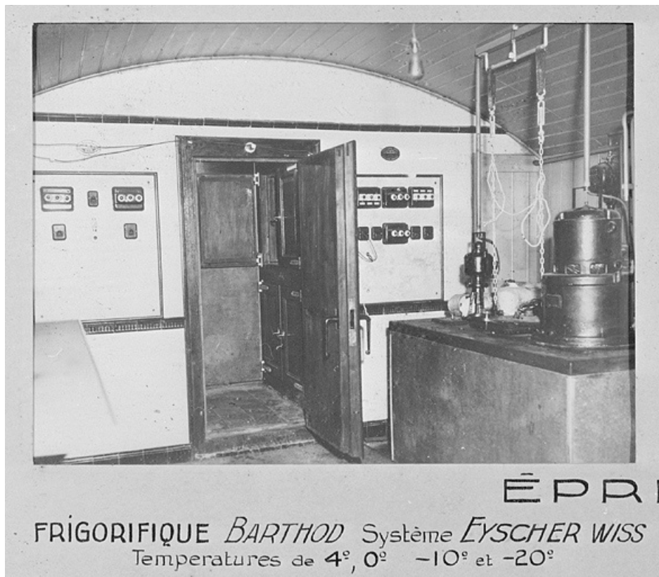
Epreuves thermiques. Frigorifique Barthod Système Eyscher Wiss. Températures de 4°, 0°, -10° et -20°, entre 1932 et 1934. 25, Besançon, 34, 36, 41 à 43 avenue de l' Observatoire, lieudit : la Bouloie
