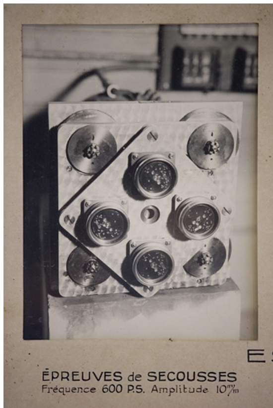
Essais de vibrations. Epreuves de secousses. Fréquence 600 P.S. Amplitude 10 m/m, entre 1932 et 1934. 25, Besançon, 34, 36, 41 à 43 avenue de l' Observatoire, lieudit : la Bouloie
