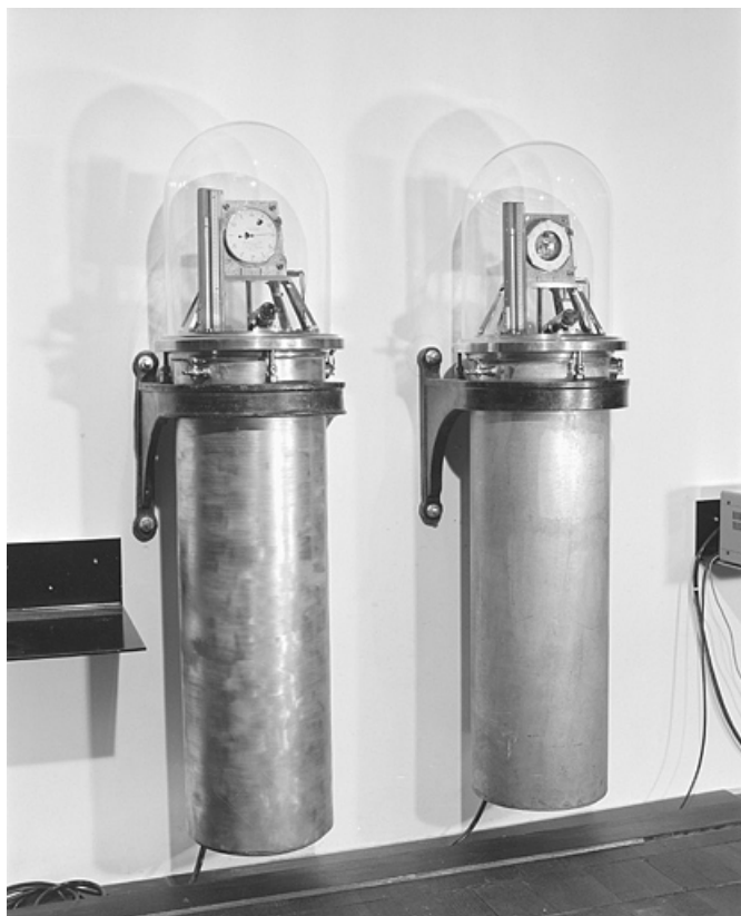
Deux horloges à pression constante (Leroy n° 1450 et 1723, exposées au Musée du Temps). 25, Besançon, 34, 36, 41 à 43 avenue de l' Observatoire, lieudit : la Bouloie
