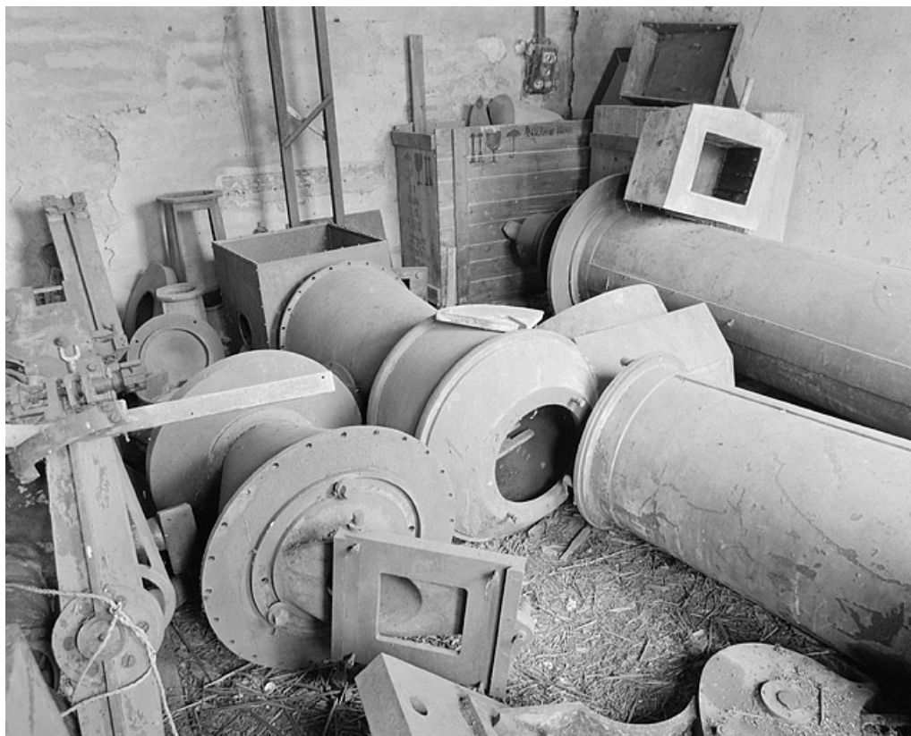
Pivot horaire inférieur et son porte-miroir, près de l'ensemble contrepoids (au centre). Cube objectif au fond près du mur, tube oculaire et tube objectif à droite.
