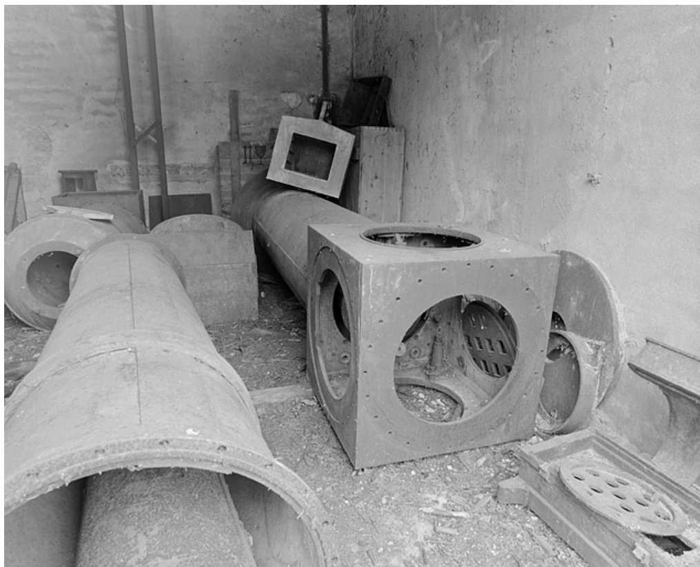
Tubes oculaires extérieur et intérieur, embase du pivot horaire inférieur, cube central et tube objectif. 25, Besançon, 34 avenue de l' Observatoire, lieudit : la Bouloie
