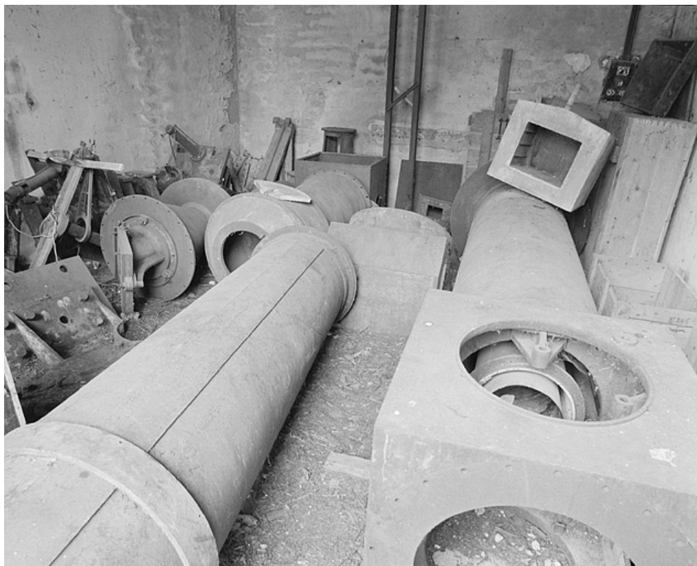
Au fond, embase du pivot horaire supérieur, pivot horaire inférieur et son porte-miroir, ensemble contrepoids, cube objectif et embase du pivot horaire inférieur.
