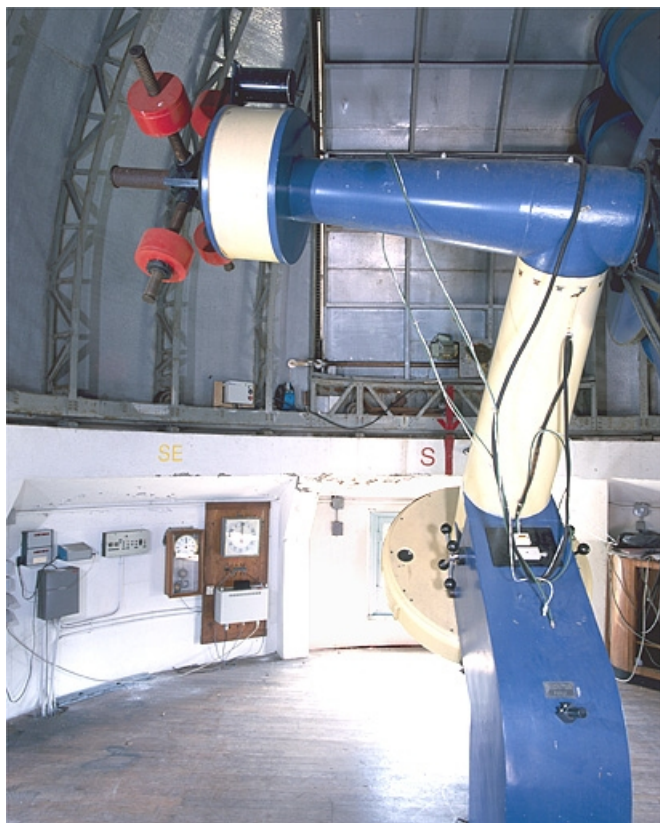
Partie contrepoids munie de quatre masses.
