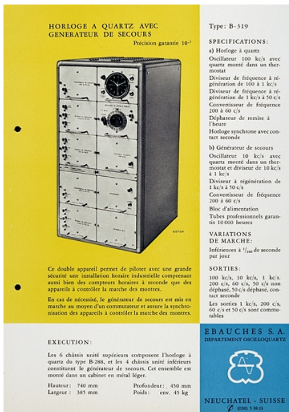
[Exemple d'appareil du département Oscilloquartz :] Horloge à quartz avec générateur de secours type B-319, vers 1955. 25, Besançon, 34, 36, 41 à 43 avenue de l' Observatoire, lieudit : la Bouloie
