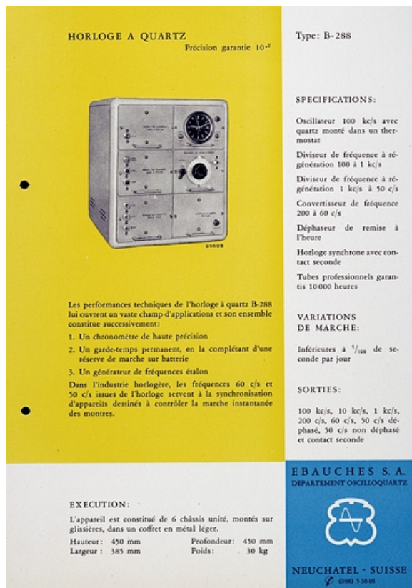
[Exemple d'appareil du département Oscilloquartz :] Horloge à quartz type B-288, vers 1955. 25, Besançon, 34, 36, 41 à 43 avenue de l' Observatoire, lieudit : la Bouloie
