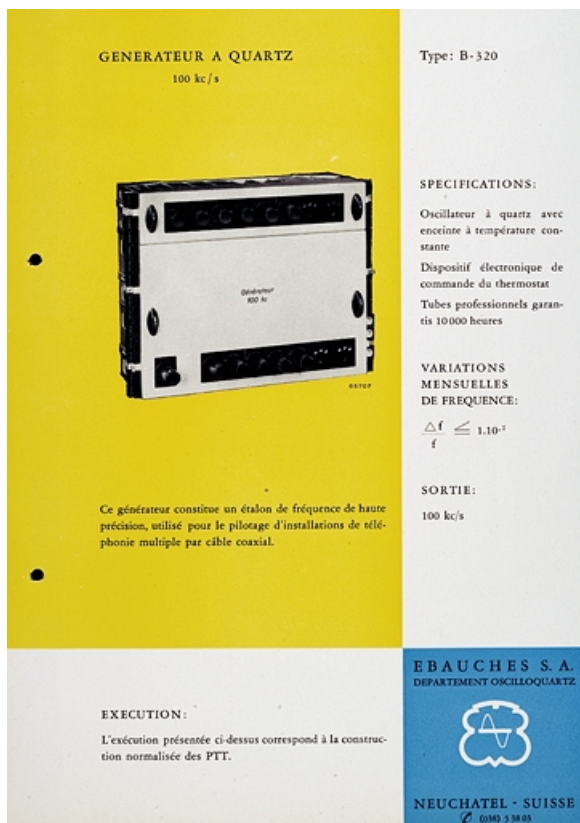
[Exemple d'appareil du département Oscilloquartz :] Générateur à quartz type B-320, vers 1955. 25, Besançon, 34, 36, 41 à 43 avenue de l' Observatoire, lieudit : la Bouloie
