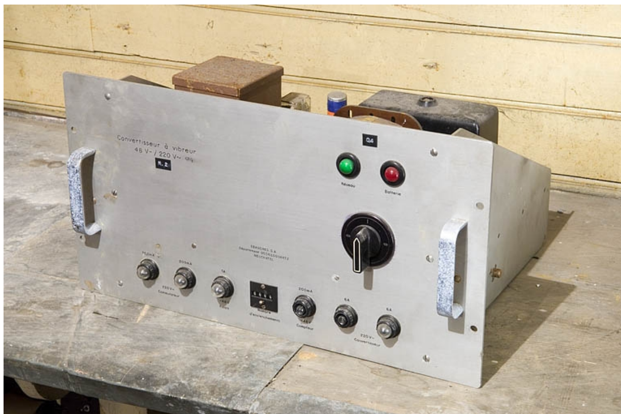
Convertisseur à vibreur équipant autrefois la station de secours (5e armoire). 25, Besançon, 34, 36, 41 à 43 avenue de l' Observatoire, lieudit : la Bouloie
