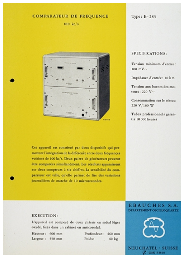
[Exemple d'appareil du département Oscilloquartz :] Comparateur de fréquence type B-283, vers 1955. 25, Besançon, 34, 36, 41 à 43 avenue de l' Observatoire, lieudit : la Bouloie
