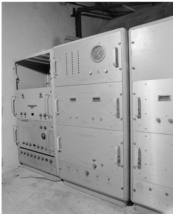
De gauche à droite, la station de secours (5e armoire) et les deux armoires des comparateurs de fréquence (3e et 4e armoires). 25, Besançon, 34, 36, 41 à 43 avenue de l' Observatoire, lieudit : la Bouloie
