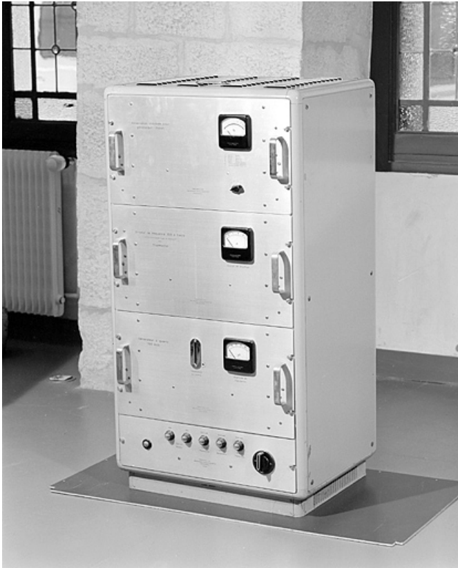
Horloge à quartz (générateur étalon) n° 24, conservée au Musée du Temps.
