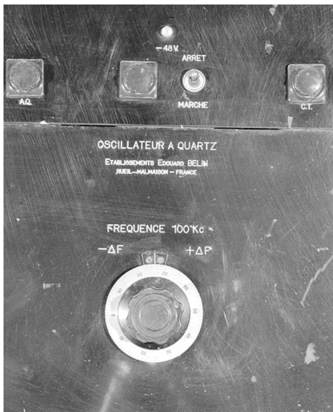
Horloge du Musée du Temps : sélecteur rotatif de l'oscillateur à quartz. 25, Besançon, 34, 36, 41 à 43 avenue de l' Observatoire, lieudit : la Bouloie
