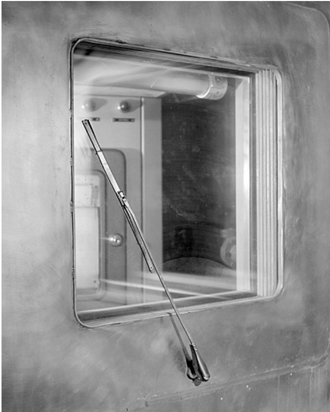
Enceinte d'essais : essuie-glace sur la face intérieure de la vitre.
