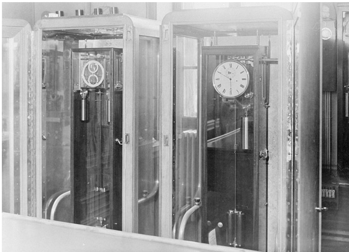
[Vue d'ensemble rapprochée de deux armoires à température contrôlée], avant 1909.
