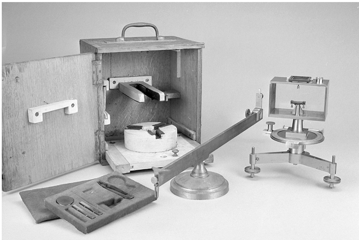
Vue d'ensemble de la balance (à droite), de ses accessoires (dont la mire) et de sa boîte de rangement.
