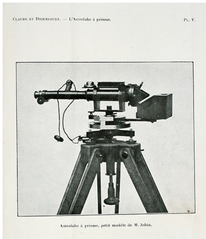
Astrolabe à prisme, petit modèle de M. Jobin, 1910.
